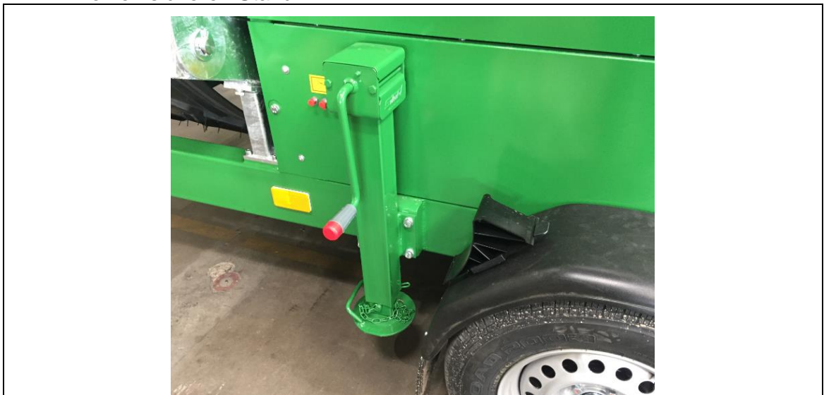
Abb. 7-1: Hintere Abstützung der Siebanlage in Transportposition
