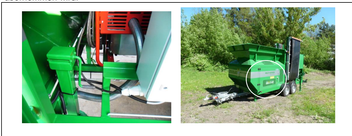
Abb. 8-3 Beispiel Verlegung Abgasschlauch
