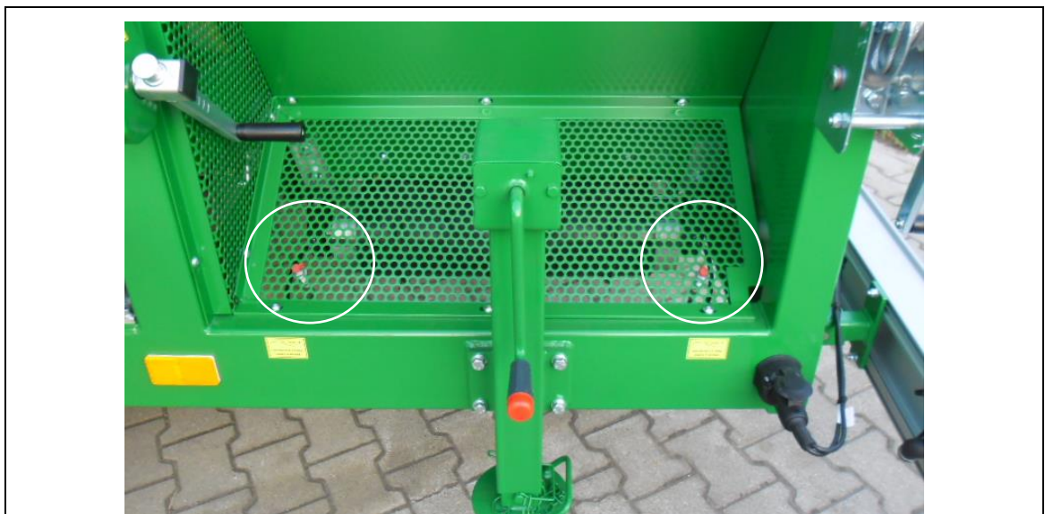
Abb. 11-7: Position der Schmierstellen der Grobfraktion
