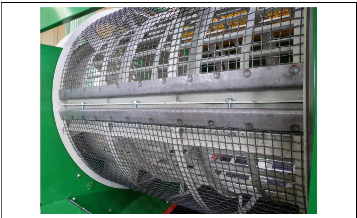
Abb. 11-3: Spannstation des Außensiebes
