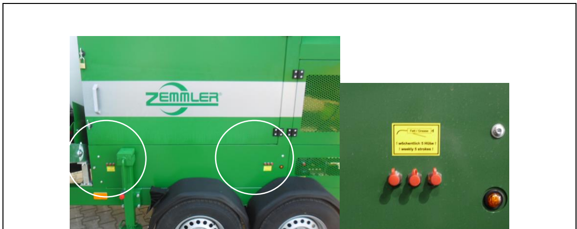
Abb. 11-7: Position der Schmierstellen der Feinfraktion und der Tragrollen
