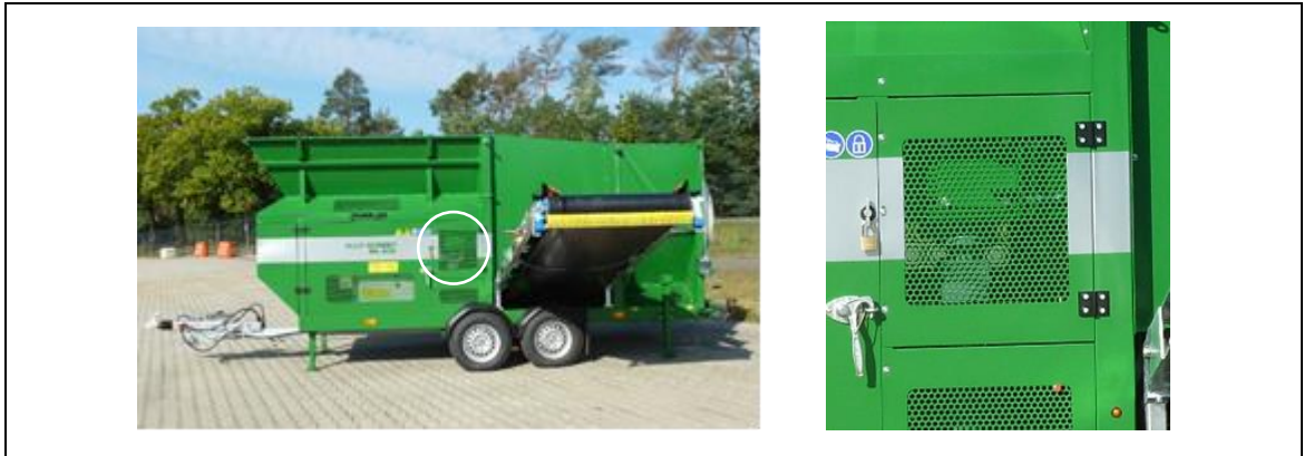
Abb. 3-3: Eingreifschutz Steuerrollen mit Sicherungselement
