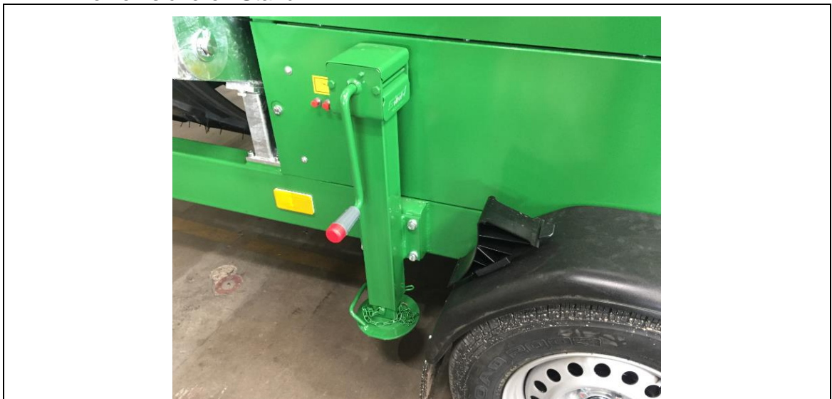
Abb. 7-1: Hintere Abstützung der Siebanlage in Transportposition
