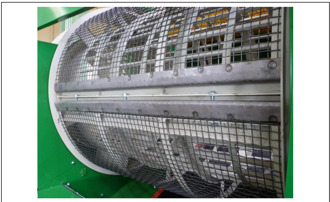
Abb. 11-3: Spannstation des Außensiebes
