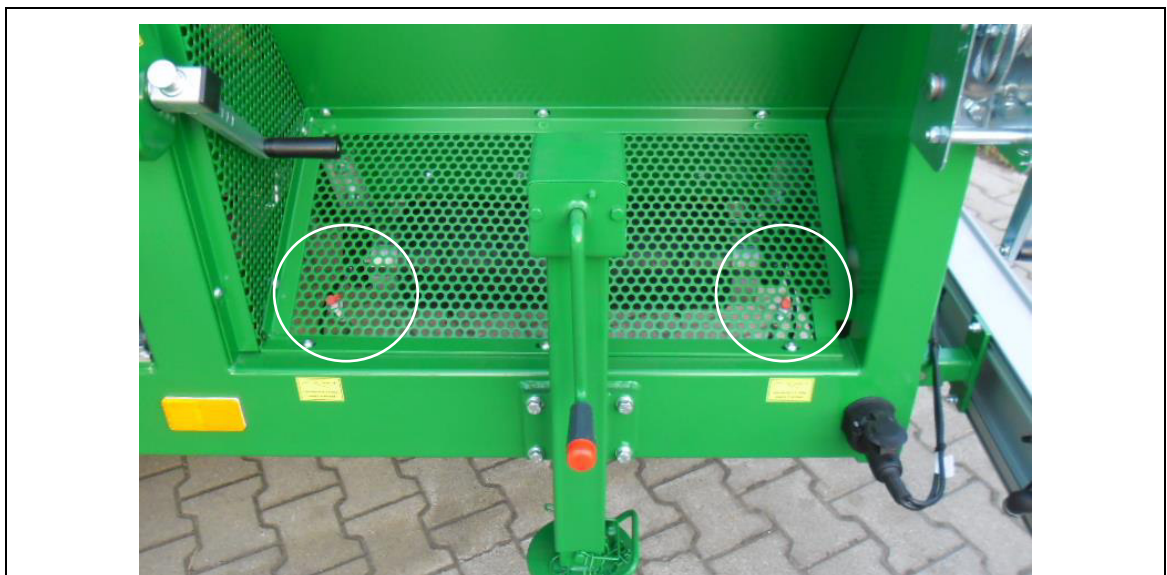
Abb. 11-8: Position der Schmierstellen der Grobfraktion
