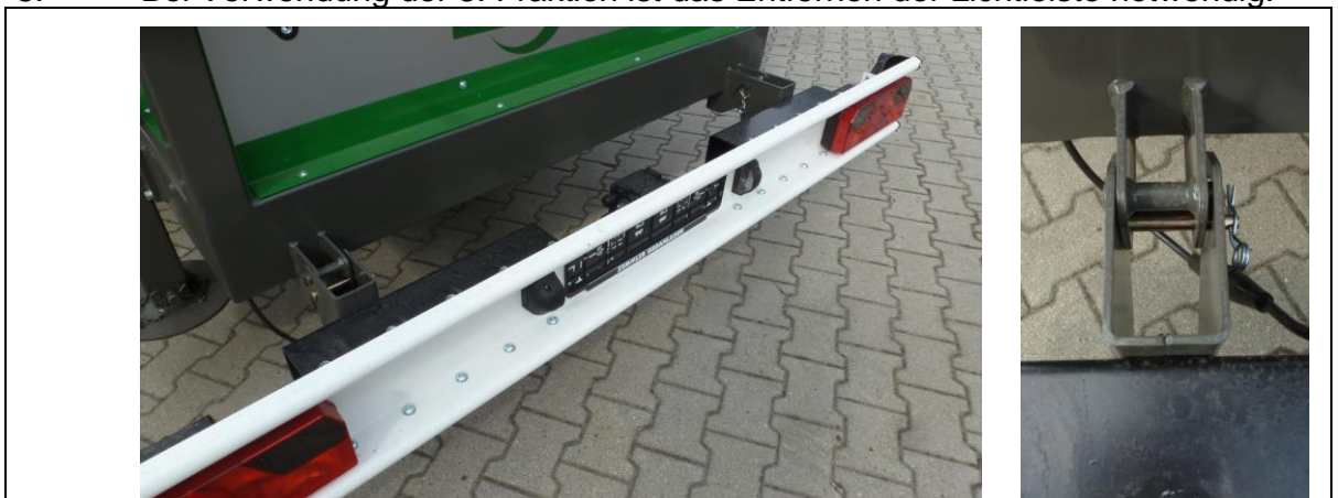
Abb. 7-3: Sicherungseinheit sowie Stromversorgung zur Lichtleiste lösen
