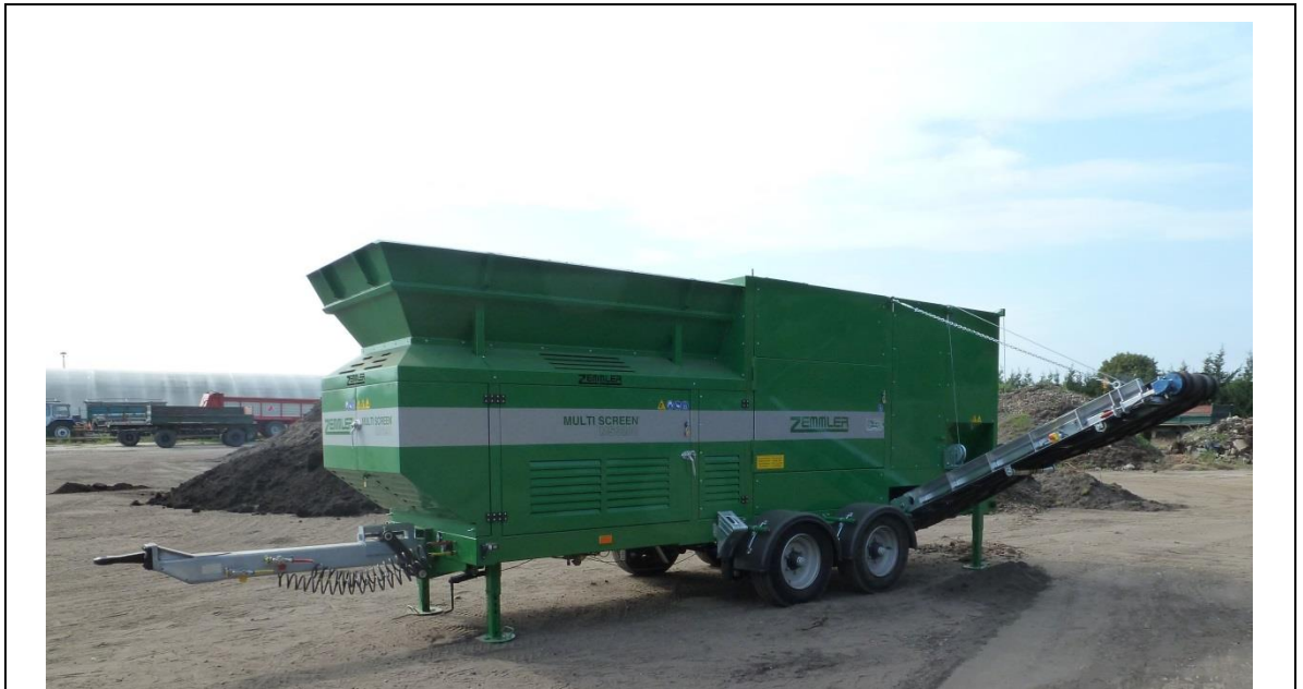
Abb. 6-1: Beispiel Siebanlage in Arbeitsposition (vorn links)
