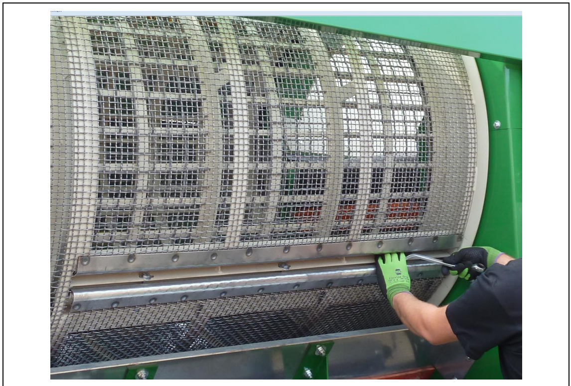
Abb. 11-3: Spann- und Befestigungsvorrichtung für Siebgitterbelag (Bsp.)
