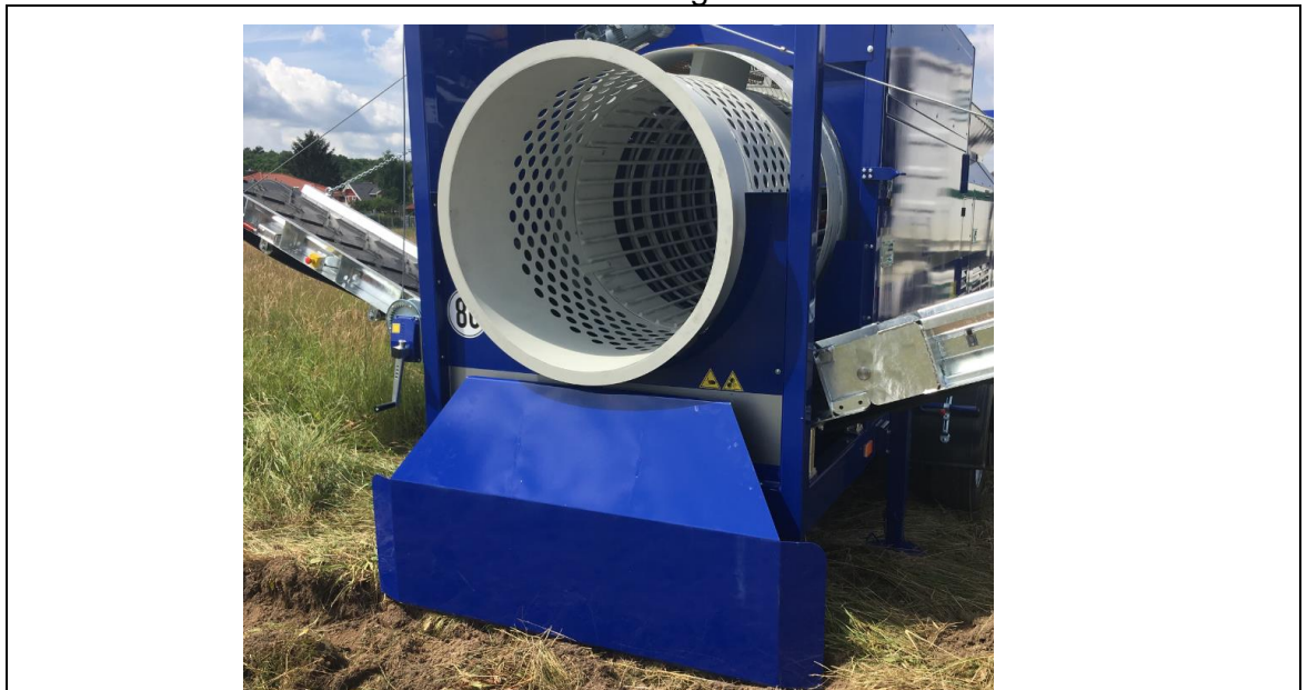
Abb. 8-3: Position des Abweiserblechs
