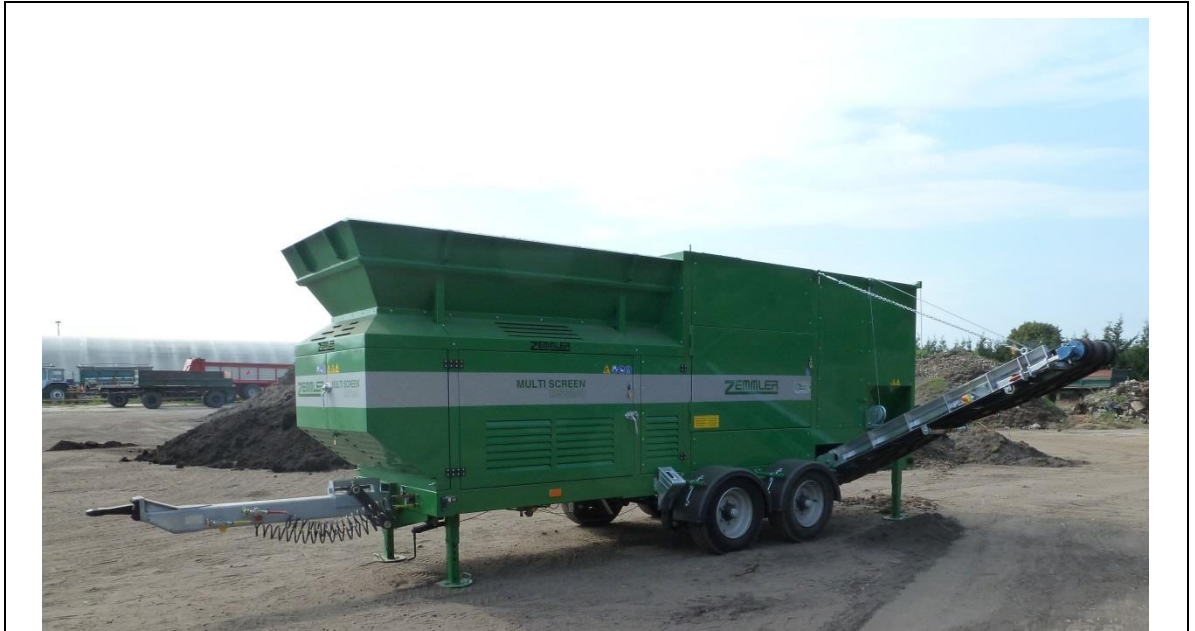
Abb. 6-1: Beispiel Siebanlage in Arbeitsposition (vorn links)
