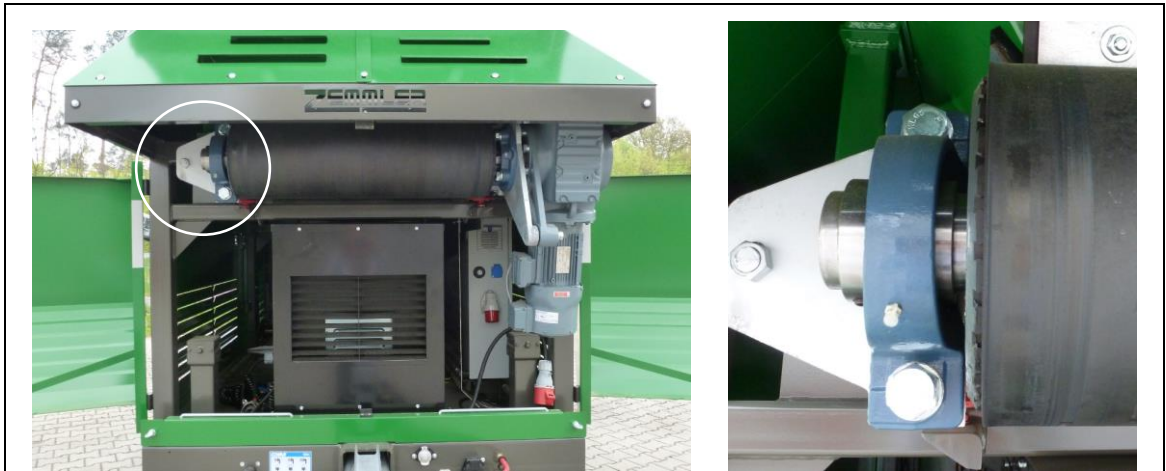
Abb. 11-9: Position der Schmierstellen am Bandaufgeber
