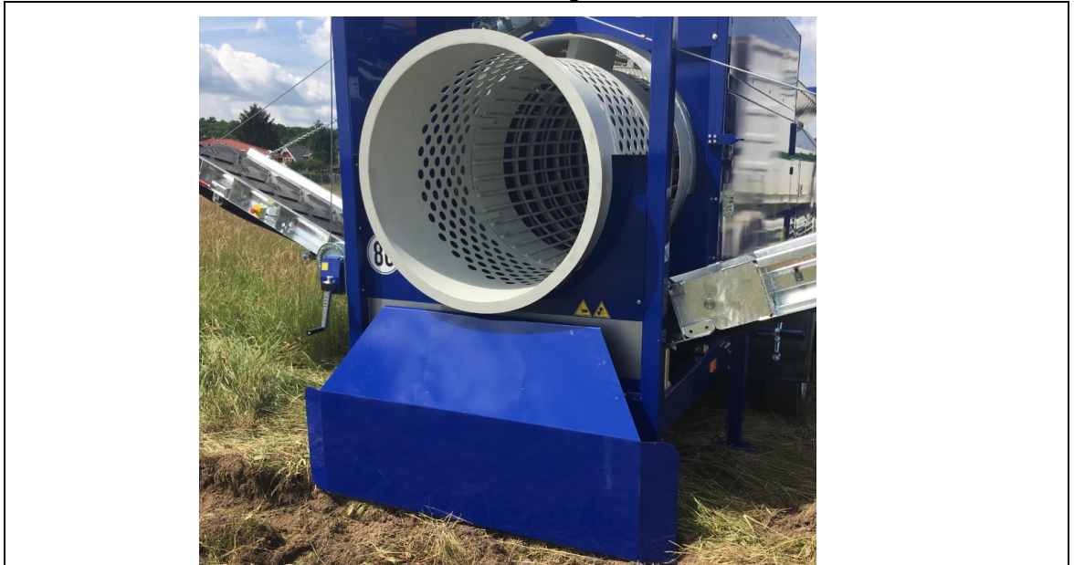
Abb. 8-3: Position des Abweiserblechs
