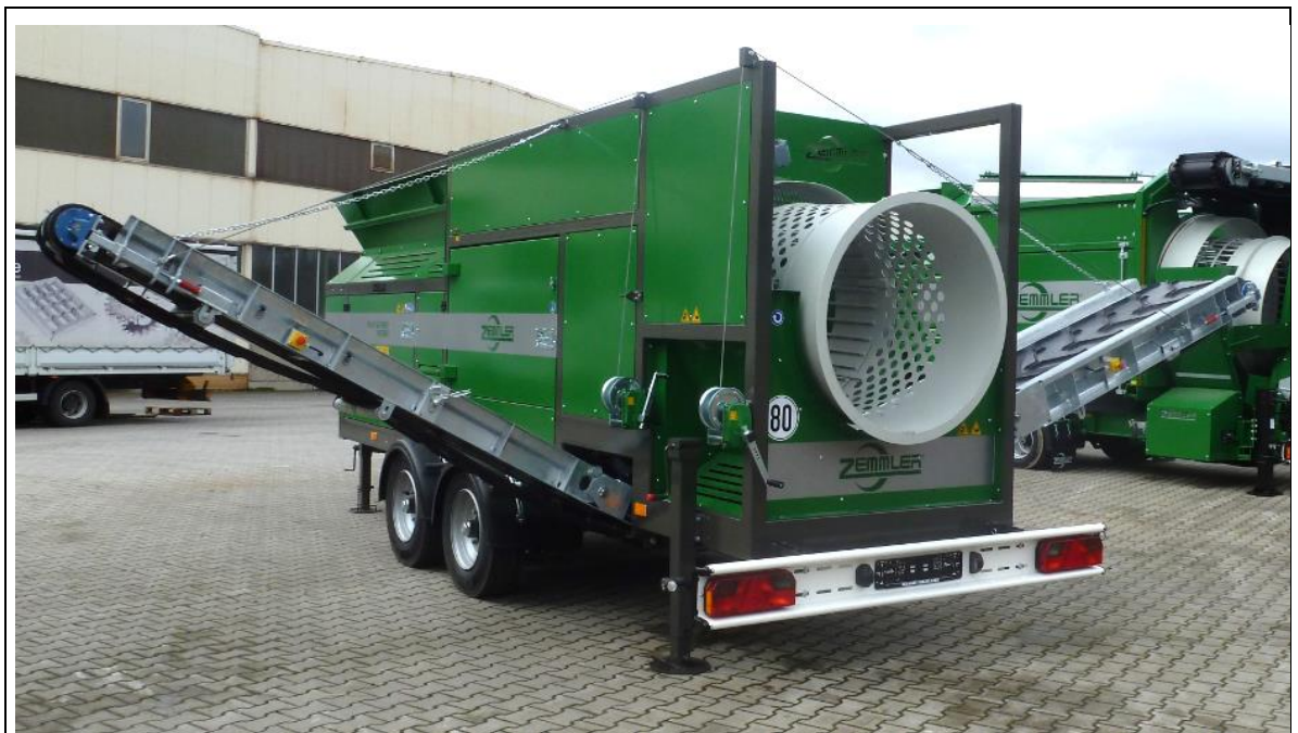
Abb. 6-2: Beispiel Siebanlage in Arbeitsposition (hinten links)
