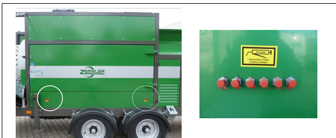
Abb. 11-8: Position der zentralen Schmierstellen
