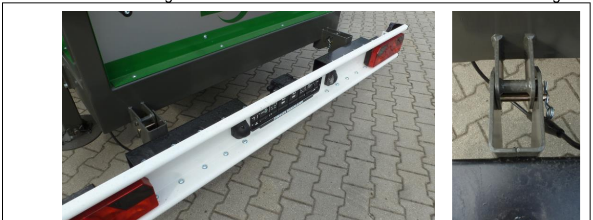
Abb. 7-3: Sicherungseinheit sowie Stromversorgung zur Lichtleiste lösen
