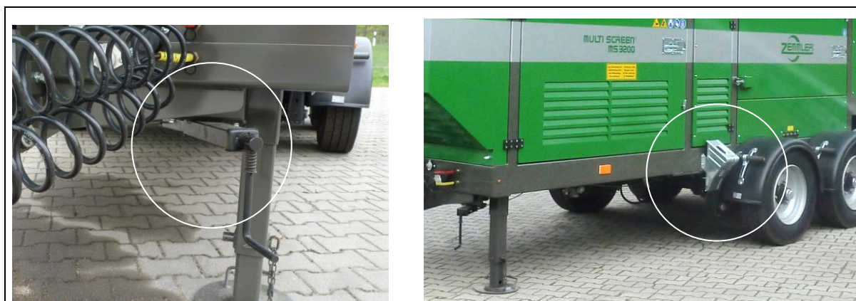
Abb. 7-1: Position Feststellbremse und Hemmschuhhalter
