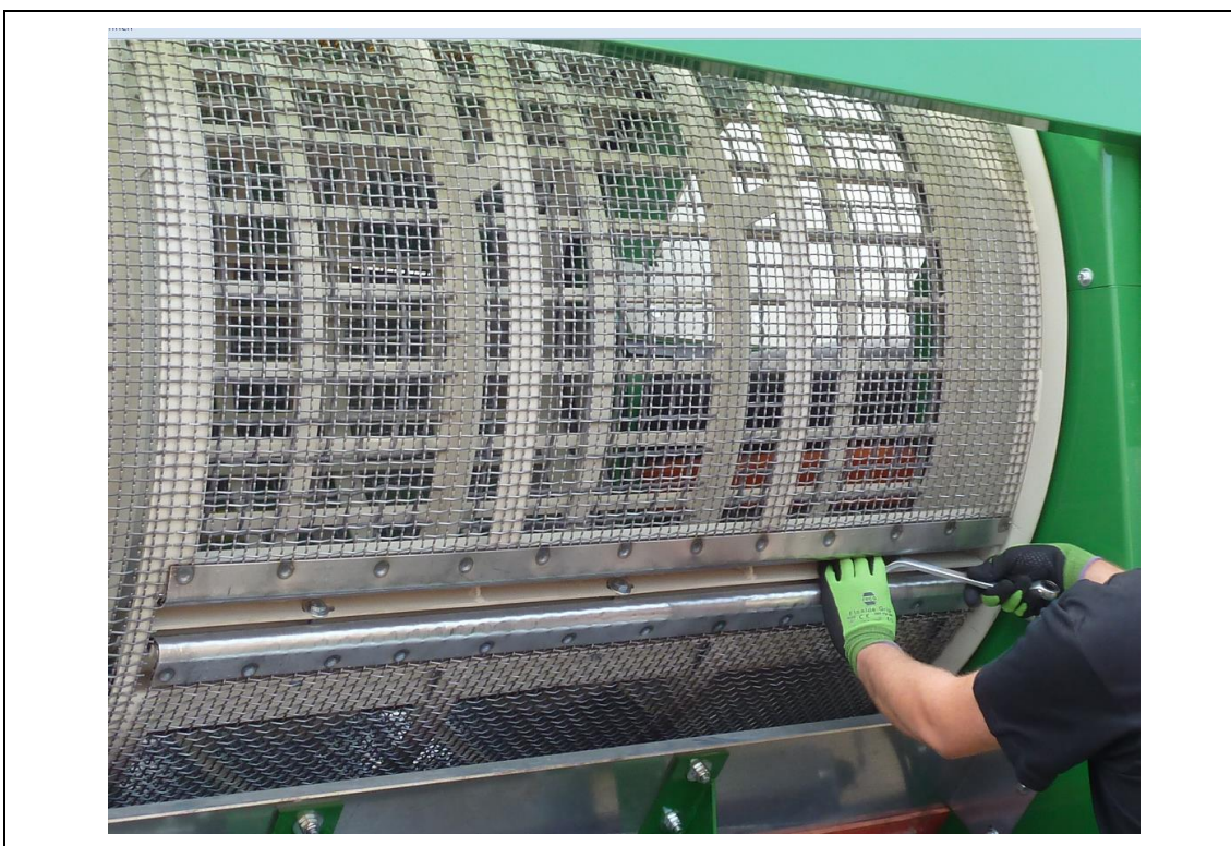
Abb. 11-3: Spann- und Befestigungsvorrichtung für Siebgitterbelag (Bsp.)
