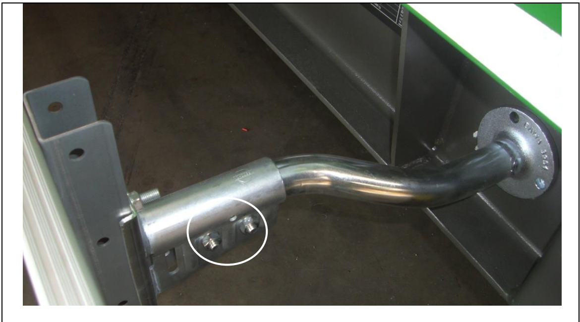
Abb. 7-10: Detail Seitliche Schutzeinrichtung
