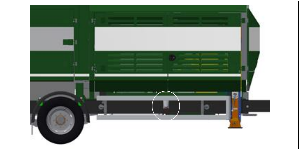
Abb. 4-2: Festnetzanschluss 400V Steckdose CEE63A
