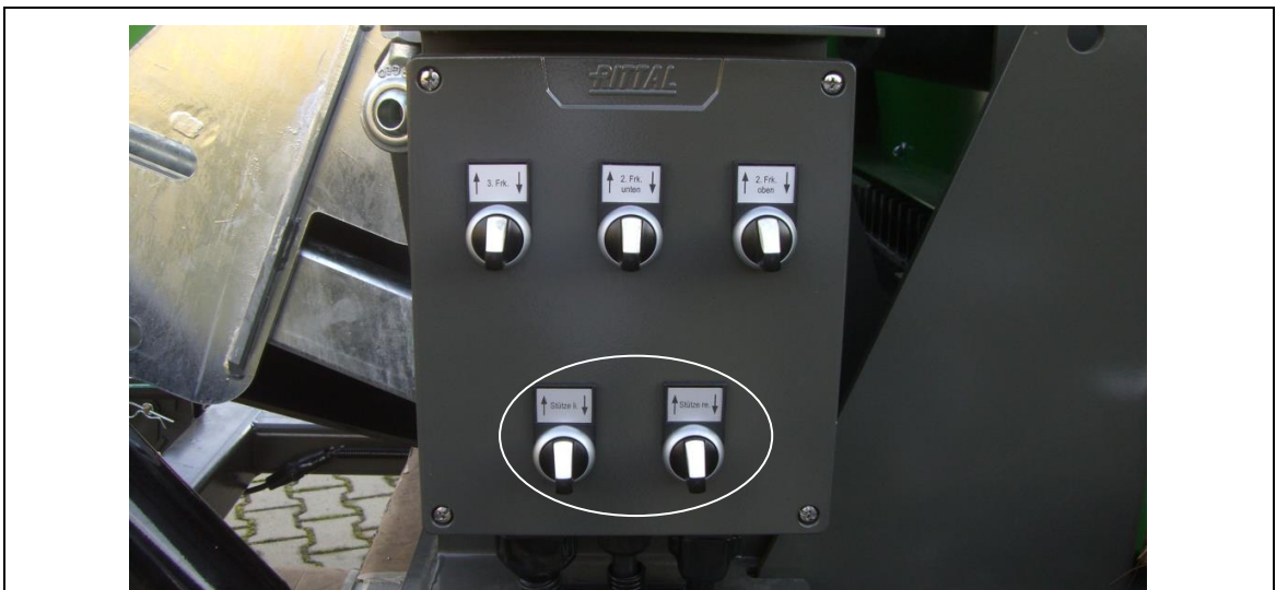
Abb. 7-3: Schaltkasten mit Knebelschalter für hintere hydraulische Stützen
