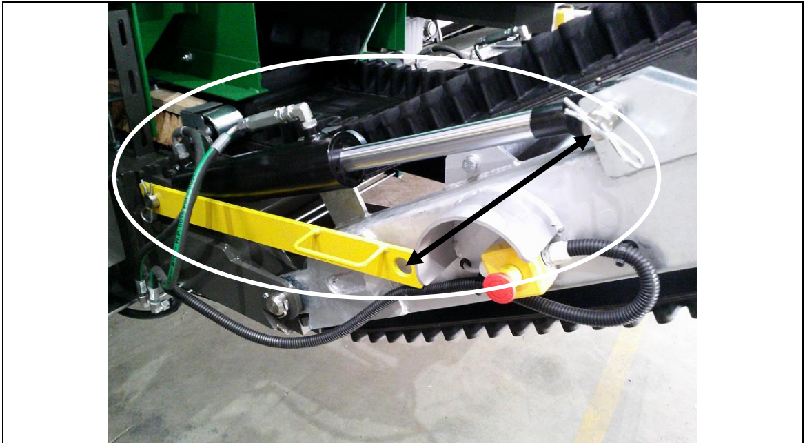
Abb. 7-5: Transportsicherung der Mittelfraktion
