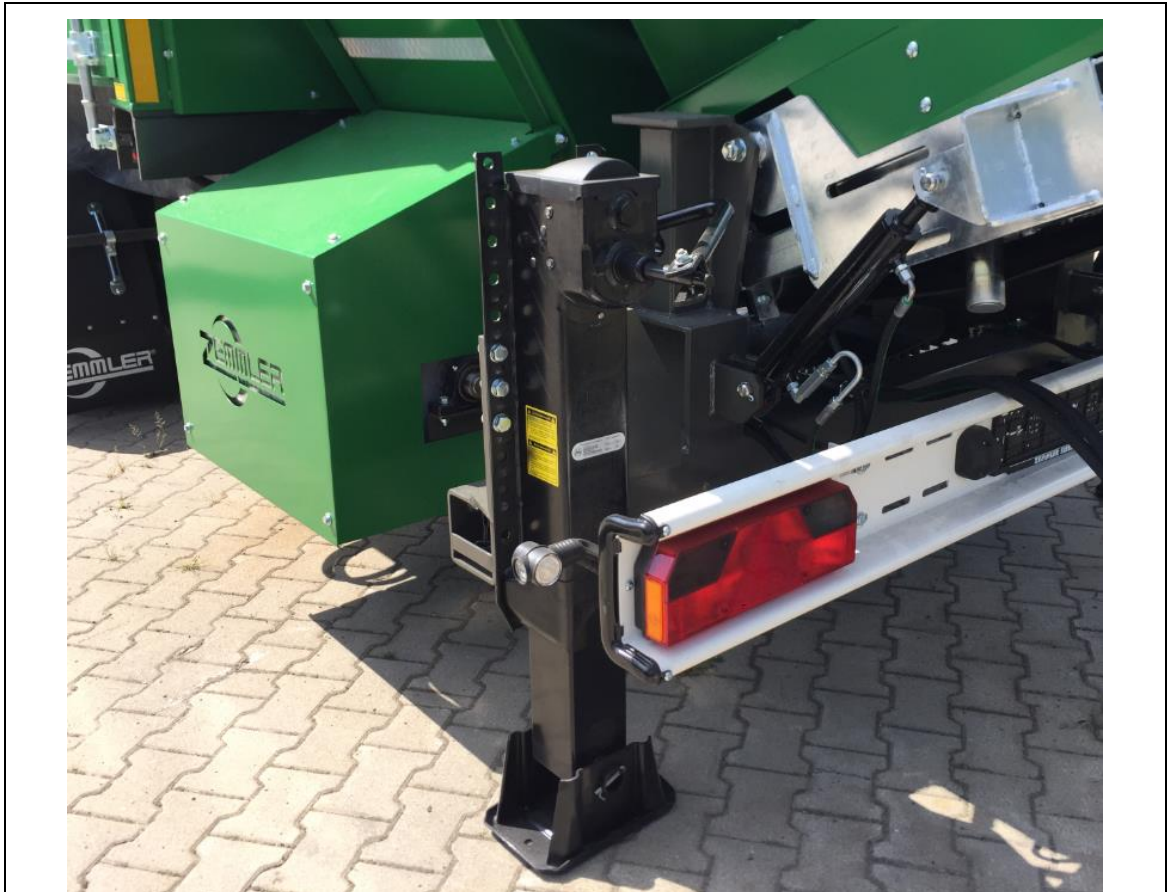
Abb. 7-1: Hintere Stützvorrichtungen der Siebanlage in Arbeitsposition
