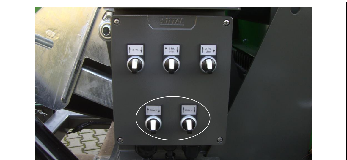
Abb. 7-3: Schaltkasten mit Knebelschalter für hintere hydraulische Stützen
