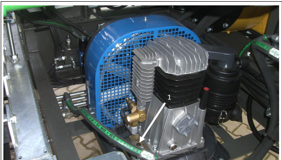
Abb. 11-8: Kompressor im Motorinnenraum
