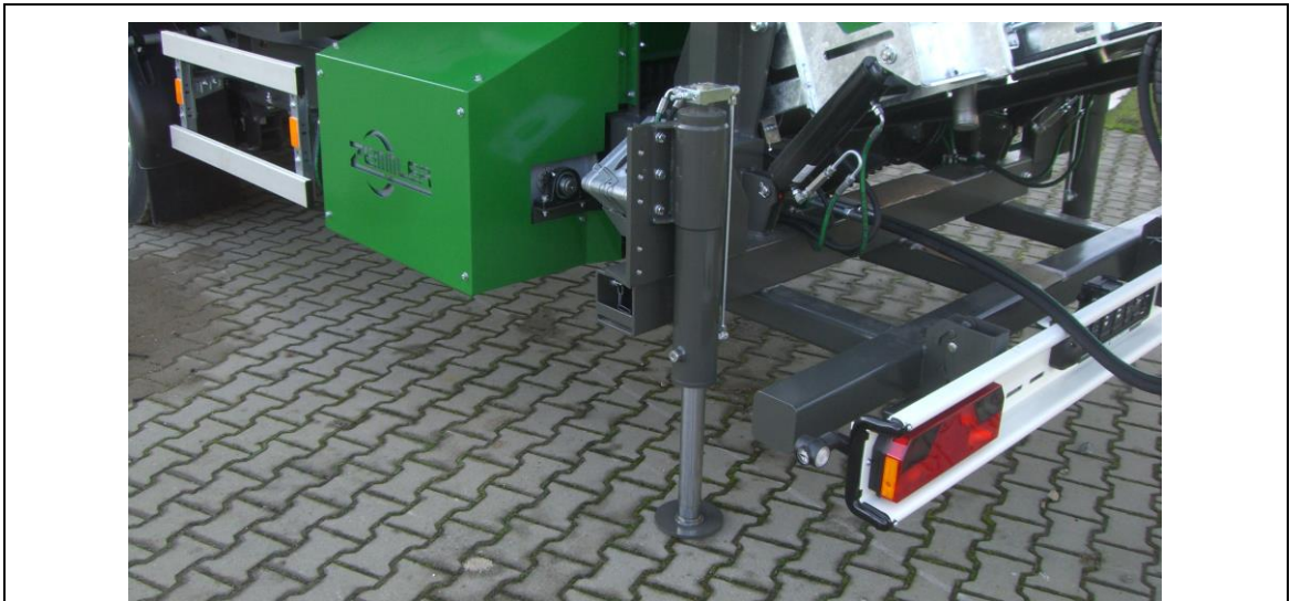
Abb. 7-2: Hintere hydraulische Stütze der Siebanlage in Arbeitsposition
