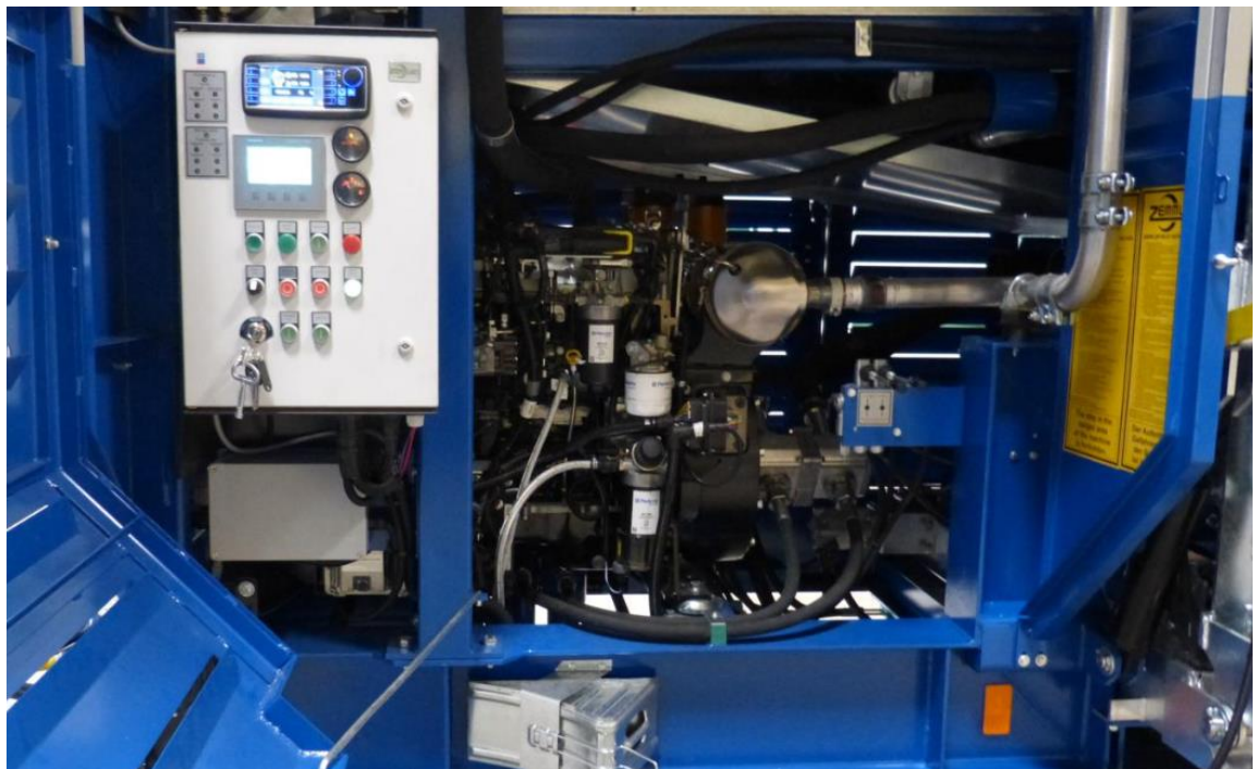
Abb. 1-1: Bedieneinheit der MS5200-059 bei geöffneter Tür
