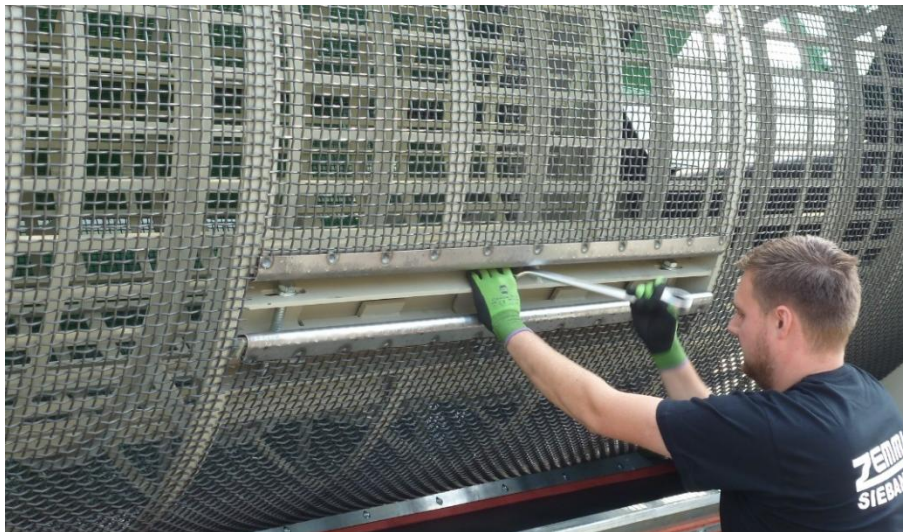
82. ábra: A rosta befogása a befogóállomással
