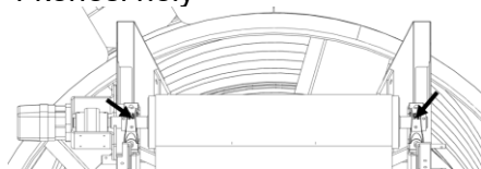
96. ábra: Rövid durva frakció kenési helyeinek helyzete felül (29k,30k)
