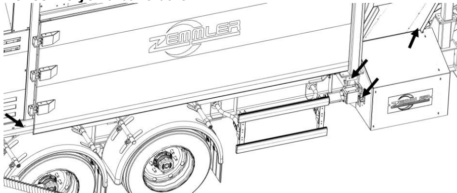
97. ábra: Kenési helyek helyzete a ház bal oldalán (31,32,33,37,38,41,42)
