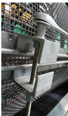
84. ábra: A rosták befogása a befogó segédeszközzel
