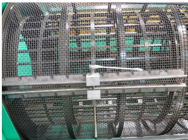
84. ábra: A rosták befogása a befogó segédeszközzel
