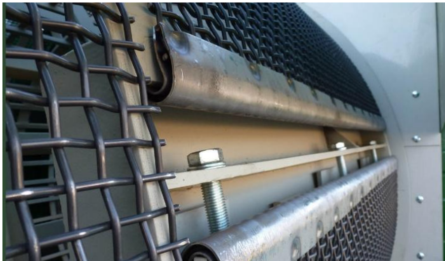
83. ábra: Befogóelemek és csavarozás a befogóállomás felett
