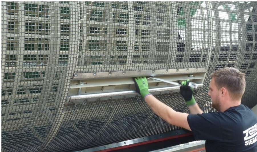
82. ábra: A rosta befogása a befogóállomással
