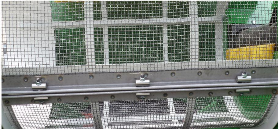
Abbildung 41: Spannelemente und Verschraubung ohne Spannstation
