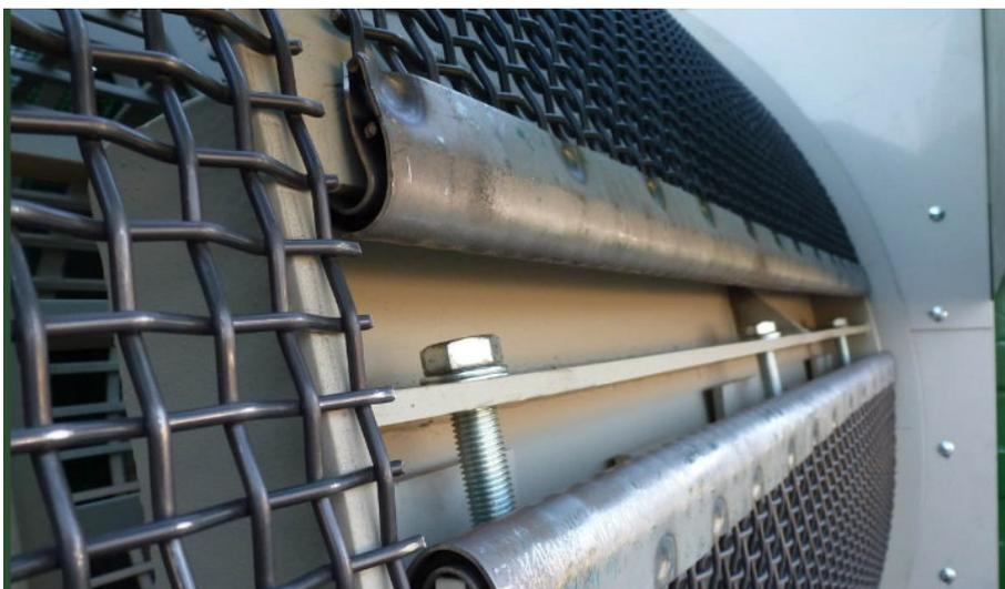
Abbildung 39: Spannelemente und Verschraubung über Spannstation
