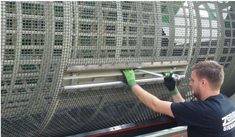
Abbildung 38: Spannen der Siebe mit Spannstation
