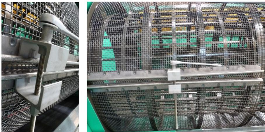
Abbildung 40: Spannen der Siebe mit Spannhilfe
