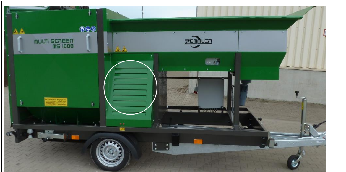
Afb. 3-3: Veiligheidsvoorziening stuurrollen met vergrendeling
