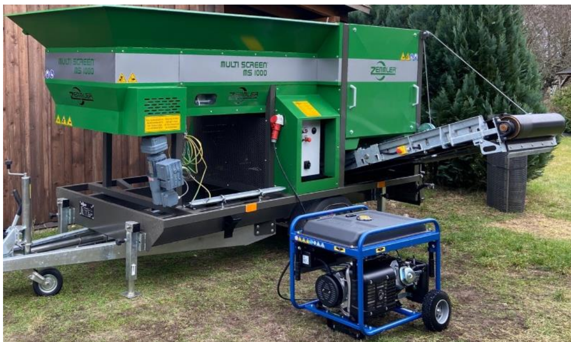
Afb. 6-1: Voorbeeld van een zeefinstallatie in werkpositie (links)
