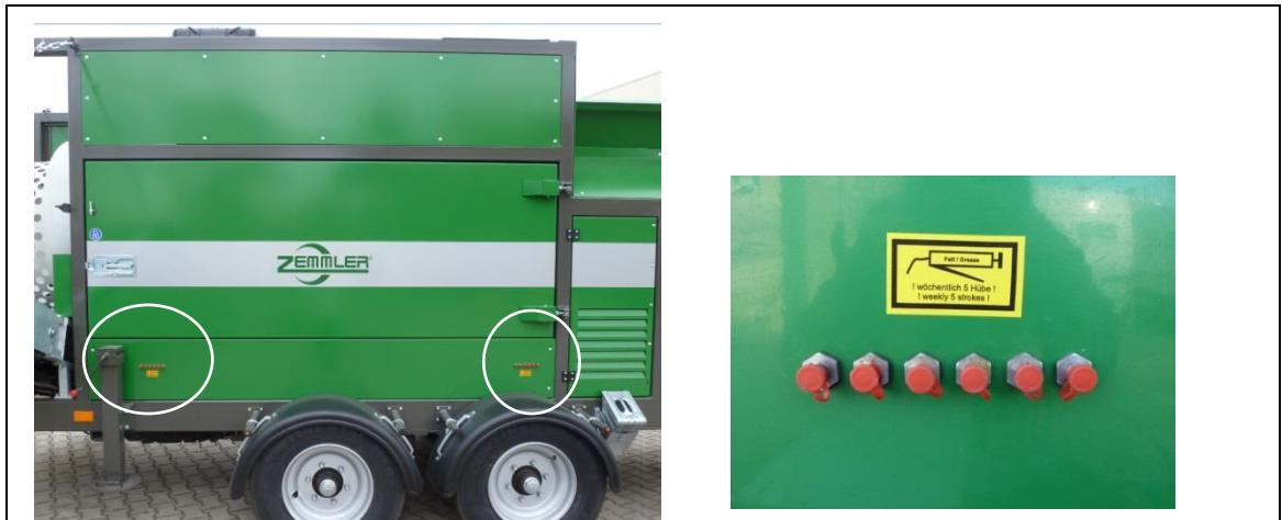
Afb. 11-7: Smeerpunten van de fijnefractieband en draagrollen
