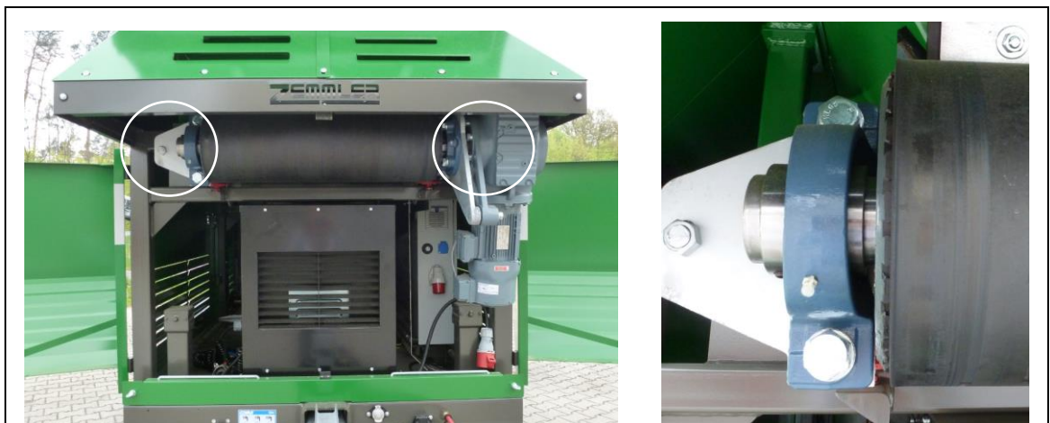
Afb. 11-9: Smeerpunten van de toevoertransportband
