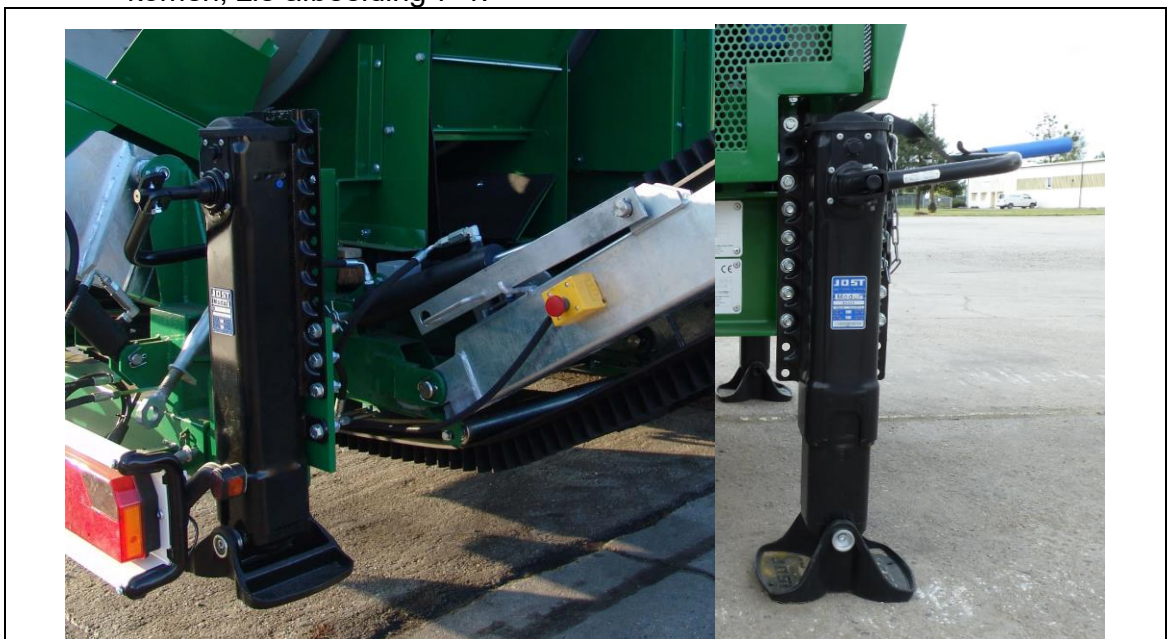
Afb. 7-1: Achterste stempels van de zeefinstallatie in transportstand
