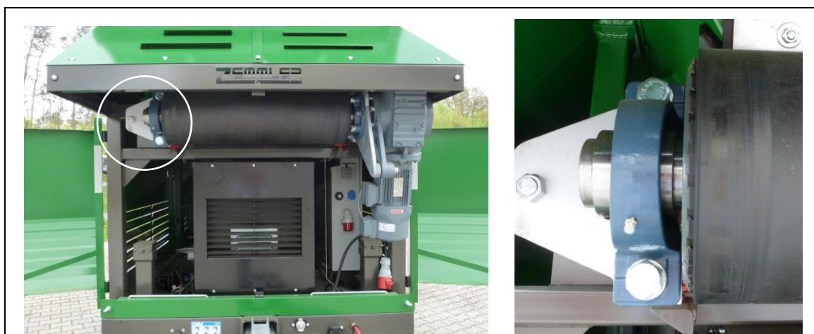
Afb. 11-10: Positie van de smeerpunten op de invoerband
