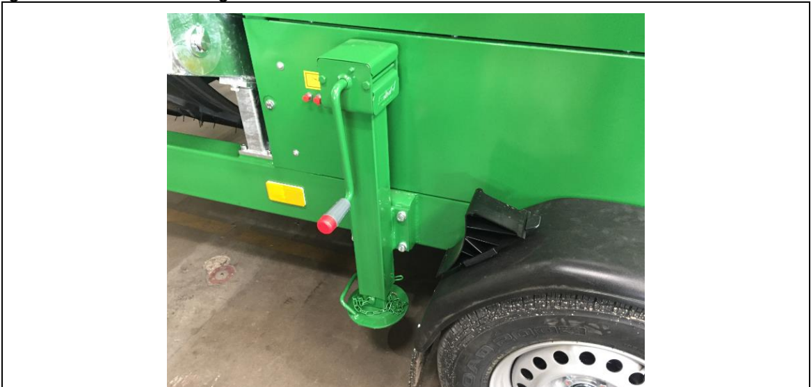
Afb. 7-1: Achterste ondersteuning van de zeefinstallatie in transportpositie
