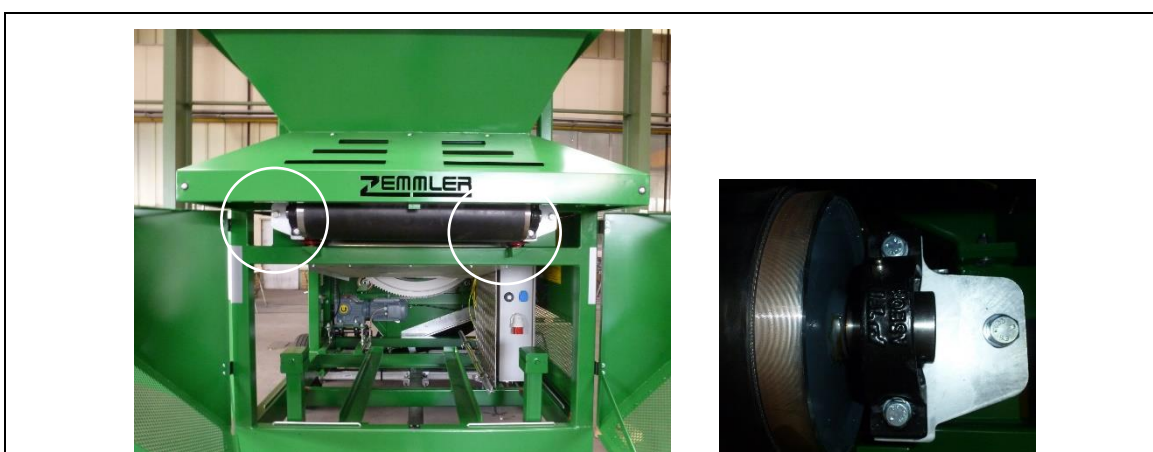
Afb. 11-9: Positie van de smeerpunten bij de bandaanvoer
