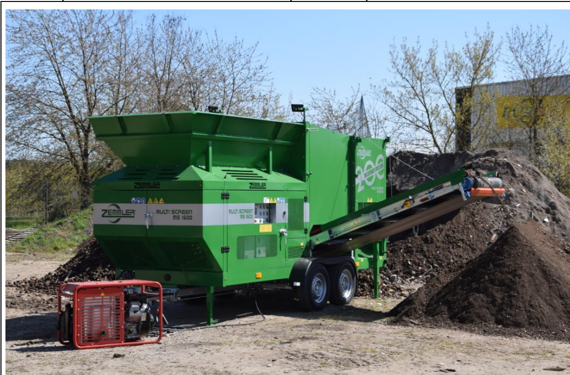
Afb. 6-1: Voorbeeld zeefinstallatie in werkstand (aanzicht van linksvoor)
