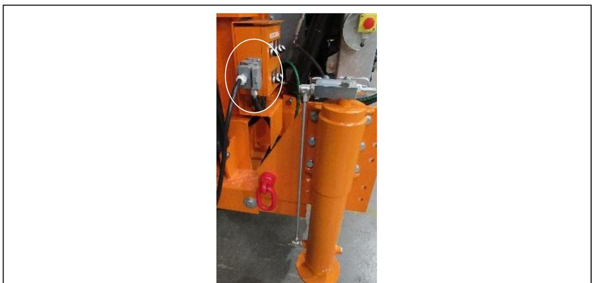
**Abb. 5-2: Anschluss Kabelfernbedienung**
