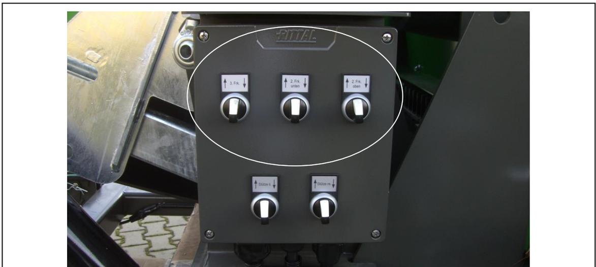
Abb. 8-3: Knebelschalter zum Ein-/Ausklappen der Mittel- und Grobfraktion
