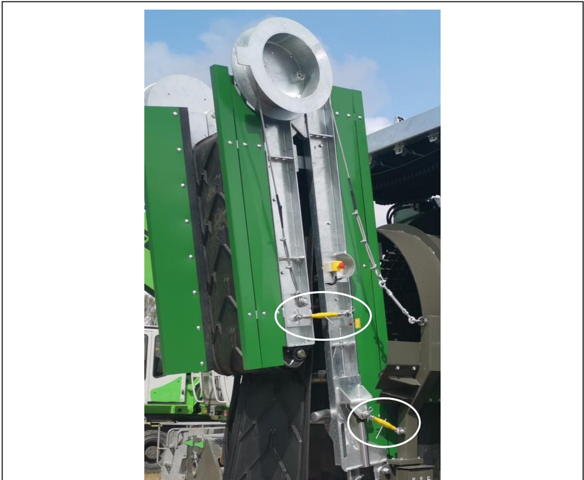
**Abb. 7-8: Transportsicherung verlängerte Grobfraction**
