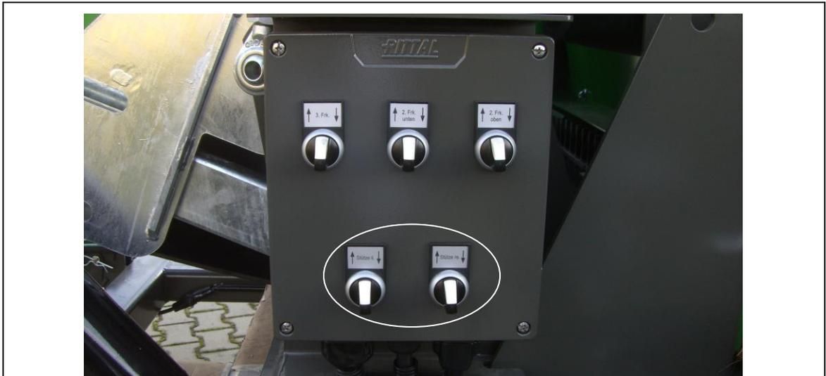
**Abb. 7-3: Kasten mit Knebelschalter für hintere hydraulische Stützen**
