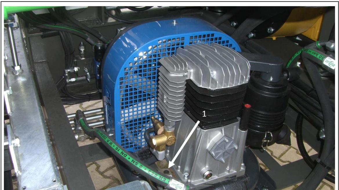
Abb. 11-8: Kompressor im Motorraum
