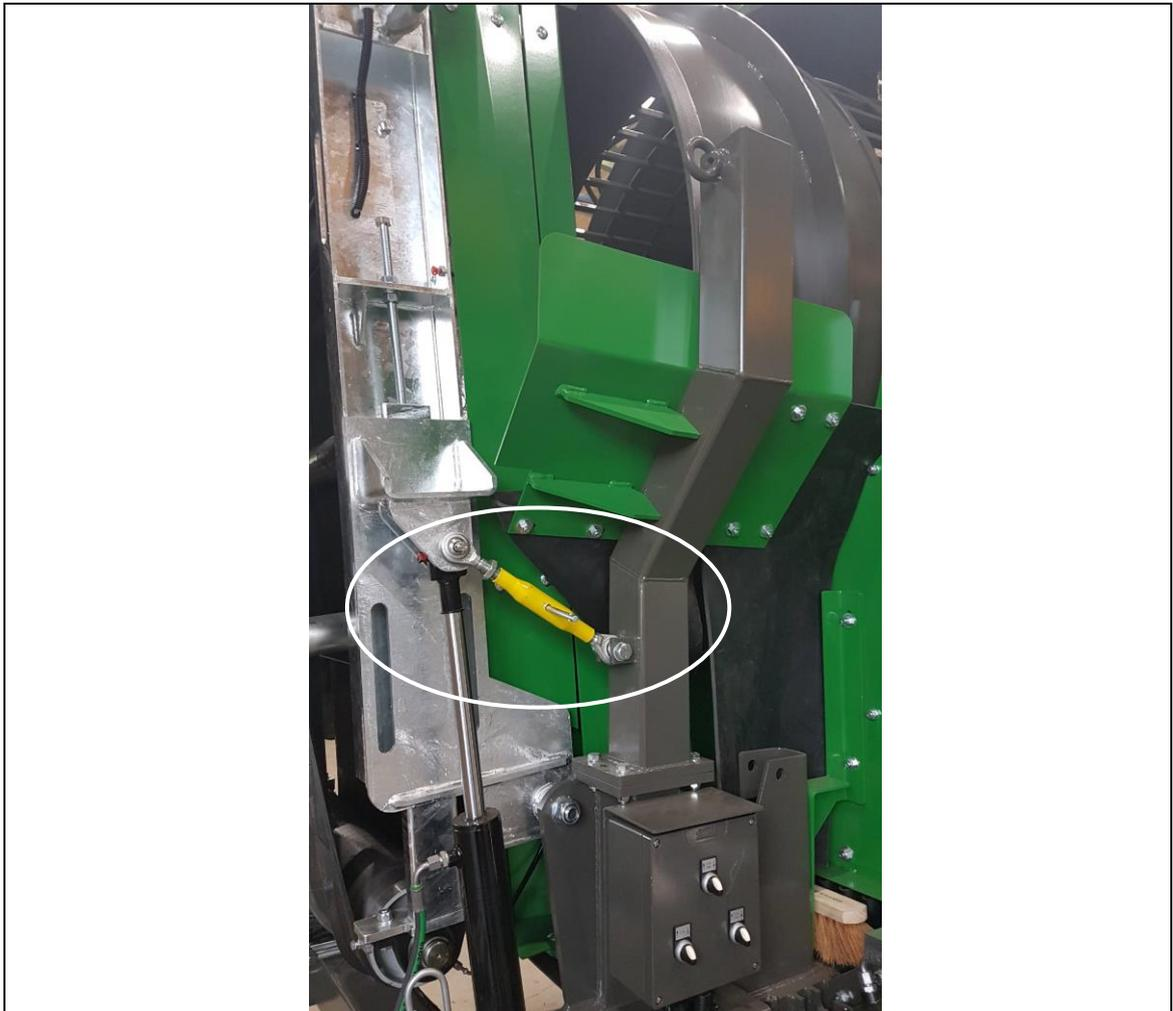
**Abb. 7-7: Transportsicherung Grobfraction**
