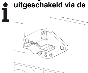
Afbeelding 15: Accuscheidingsschakelaar in de "OFF"-positie
