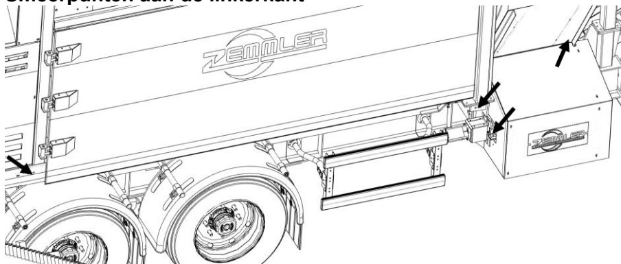
Afbeelding 97: Positie smeerpunten behuizing links (31,32,33,37,38,41,42)
