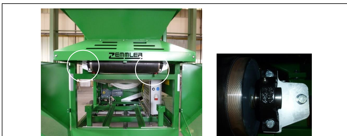
Bild 11-9: Position för bandmatarens smörjställen
