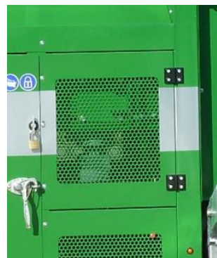
Bild 3-3: Ingreppsskydd styrrullar med säkringselement
