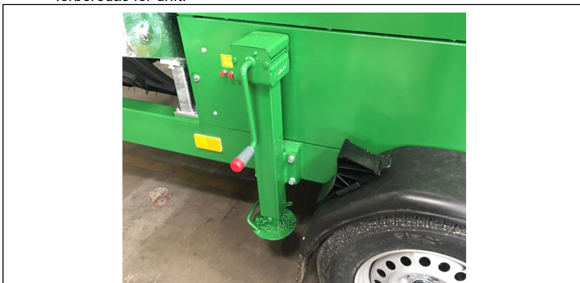
Bild 7-1: Bakre stöd på siktningsanläggningen i transportposition
