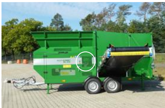
Bild 3-3: Ingreppsskydd styrrullar med säkringselement
