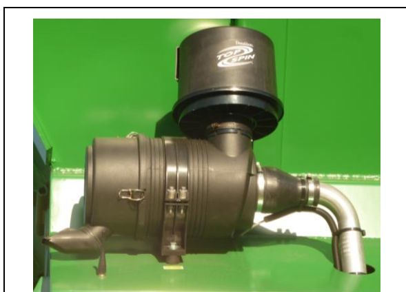
Fig. 11-6: Luftfilter med TopSpin PreCleaner
