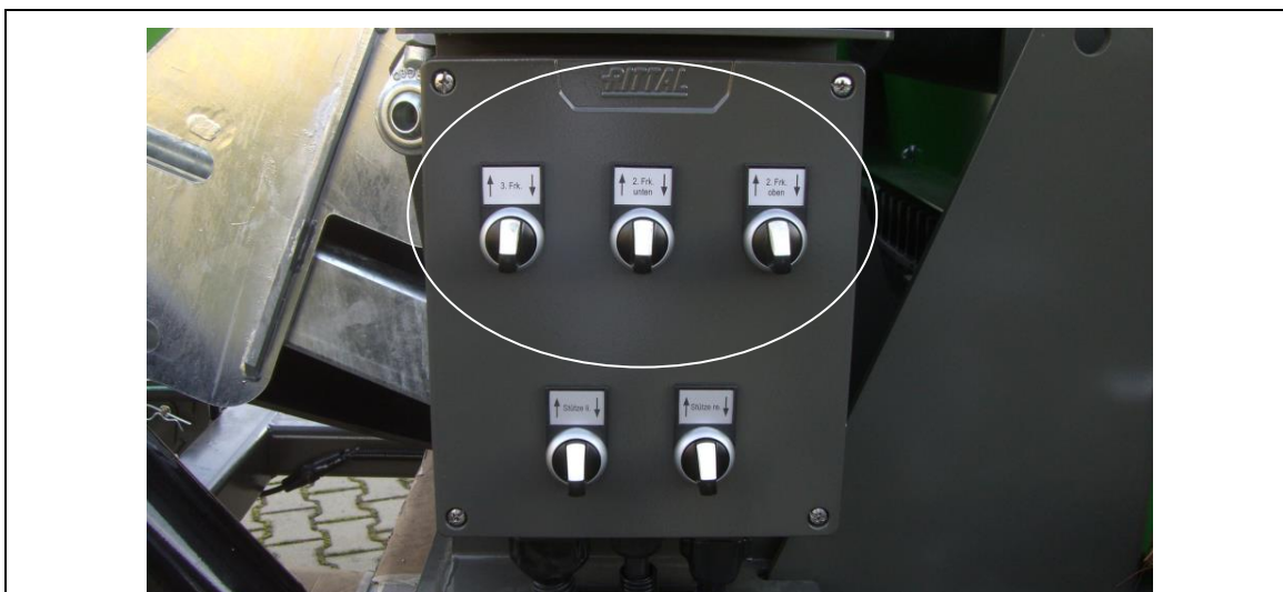
Fig. 8-3: Vekslebryter for folding/utfolding av den midtre og grove fraksjonen
