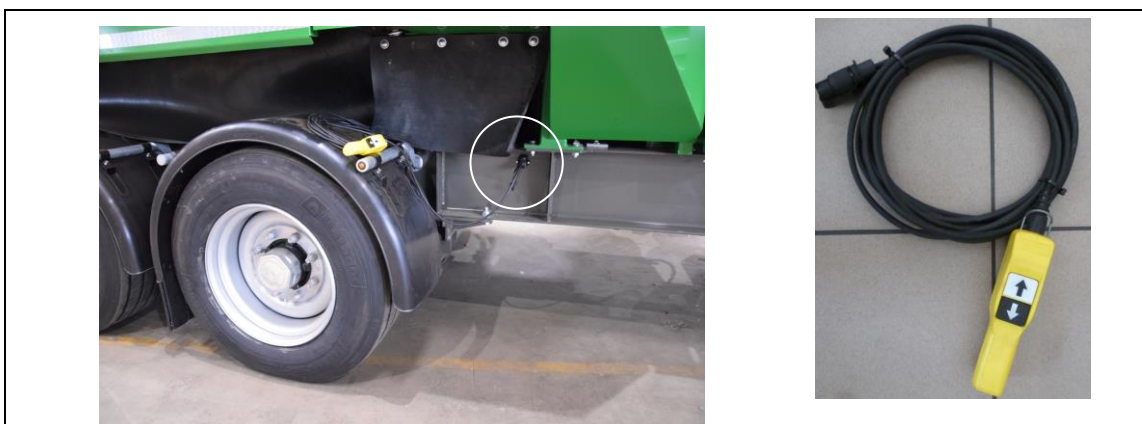
Fig. 11- 2: Strømuttak og trommelfjernkontroll
