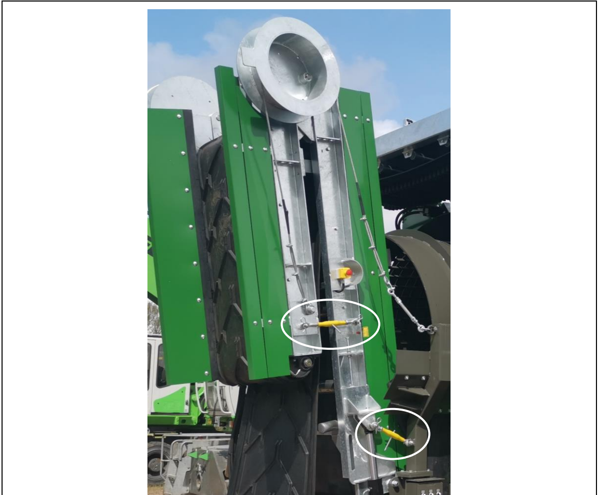
Fig. 7-8: Transport sikring av utvidet grovfraksjon
