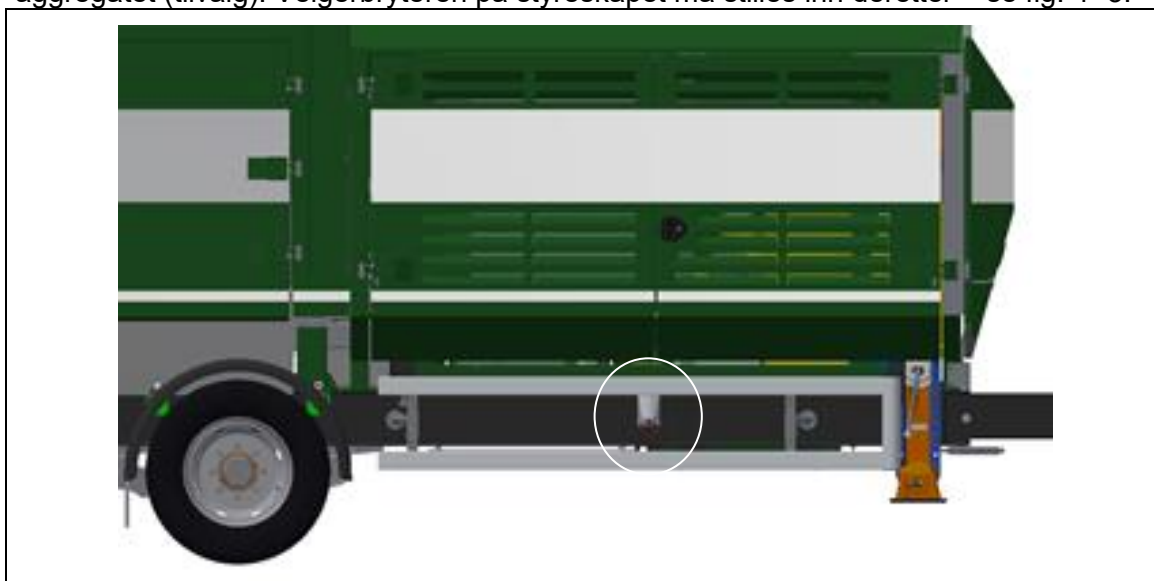
Fig. 4- 2: Fast nettverkstilkobling 400V stikkontakt CEE63A
