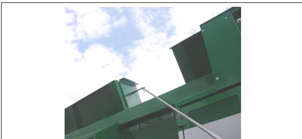
Fig. 8-4: Krokstang og malje på servicedøren
