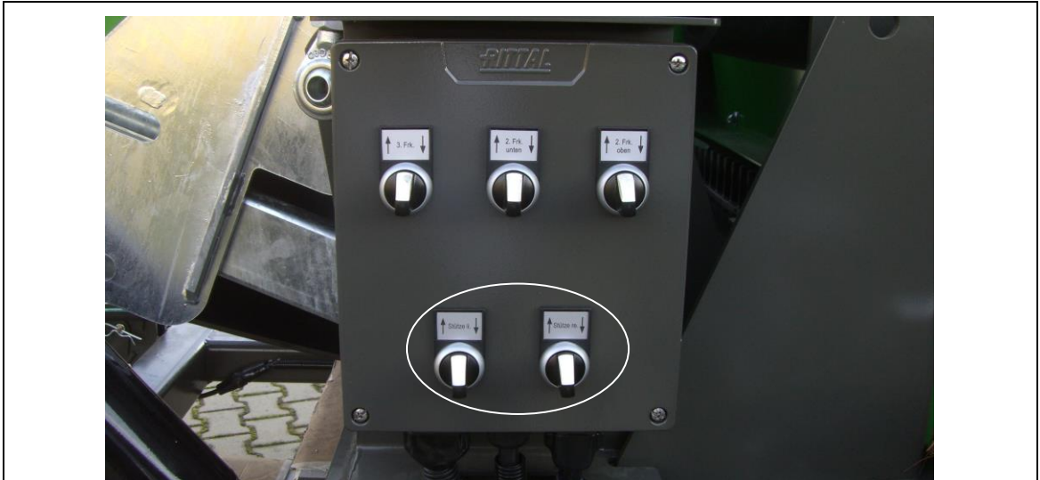
Fig. 7-3: Boks med vippebryter for bakre hydrauliske støtteben
