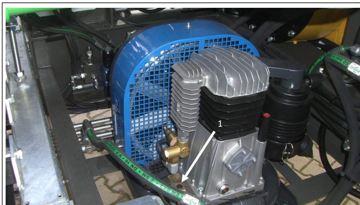
Fig. 11-8: Kompressor i motorrommet
