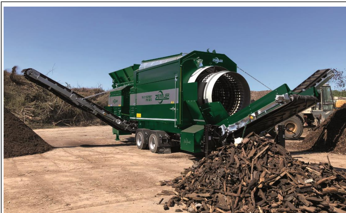
Bild 6-1: Exempel, siktningsanläggning i arbetsposition (vy bakifrån vänster)
