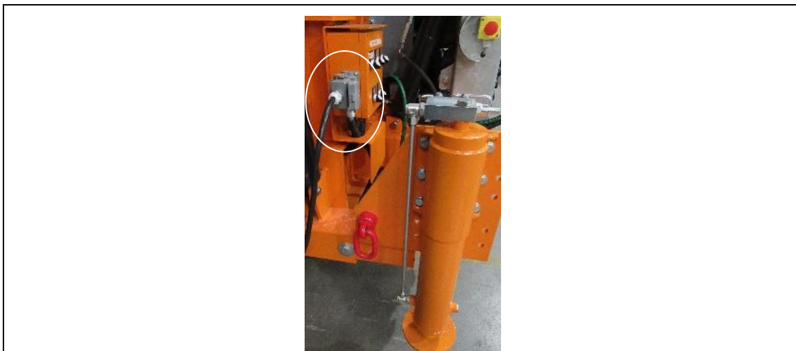
Bild. 5-4: Uppkoppling kabel fjärrkontroll
