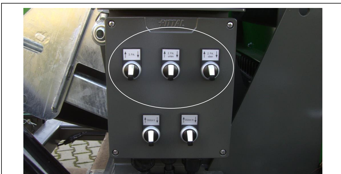
Bild 8-3: Vippströmbrytare fälla in/fälla ut medel- grovfraktionen
