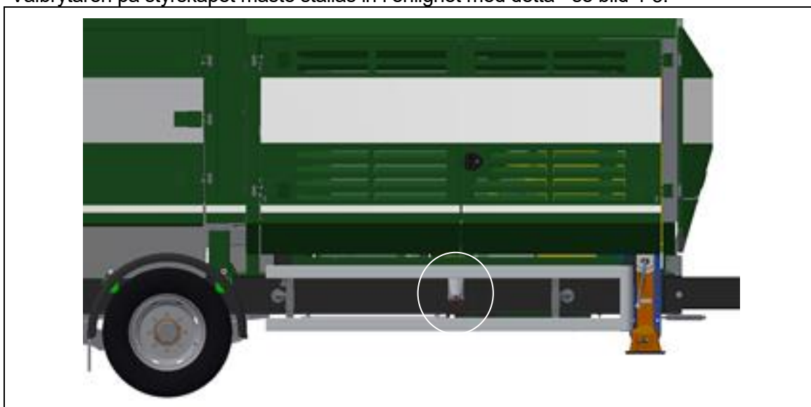
Bild. 4-2: Strömförsörjning nätansluten 400V CEE63A-uttag
