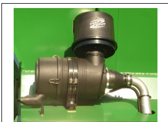
Bild 11-6: Luftfilter med TopSpin PreCleaner
