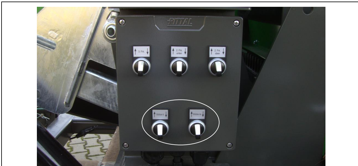
Bild 7-3: Manöverpanel med vippströmbrytare för bakre hydrauliska stöd
