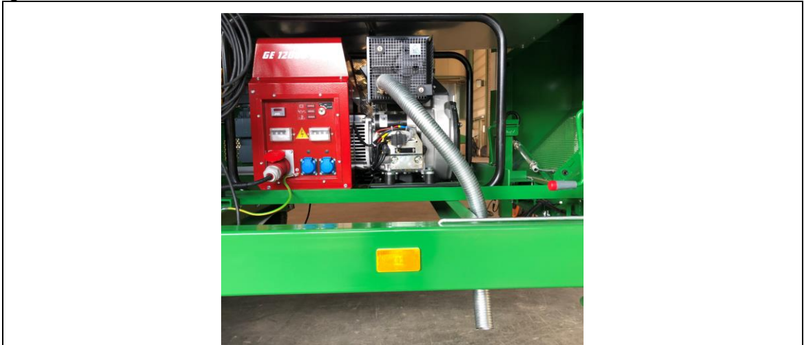
Fig. 8-3 Eksempel på føring av eksosslange
