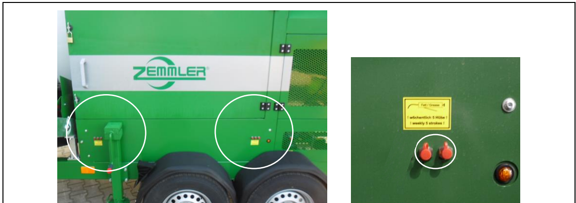
Fig. 11-7: Plassering av smørepunkter der for løpehjulene
