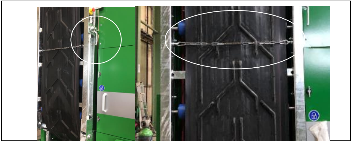
Bild 7-3: Transportsäkring för den första fraktionen
