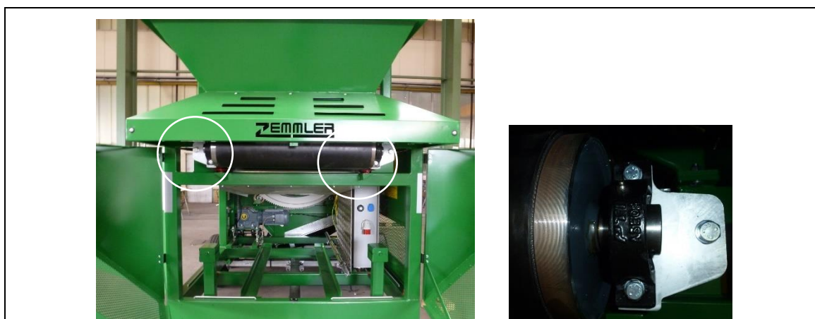
Bild 11-9: Position för bandmatarens smörjställen
