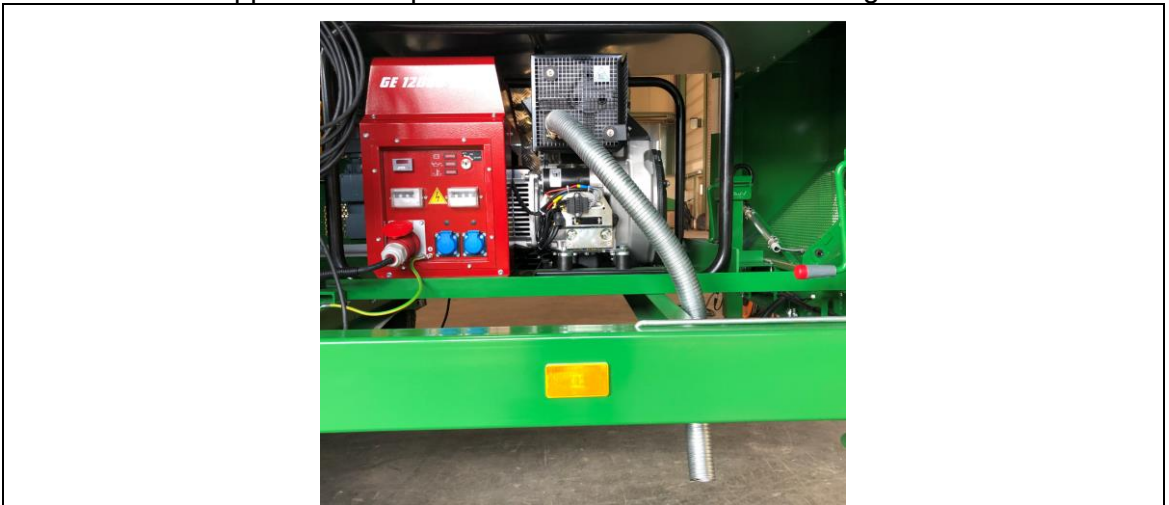
Bild 8-3 Exempel på dragning av avgasslang
