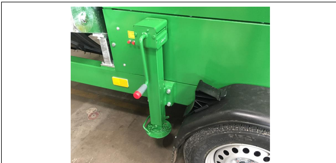
Bild 7-1: Bakre stöd på siktningsanläggningen i transportposition
