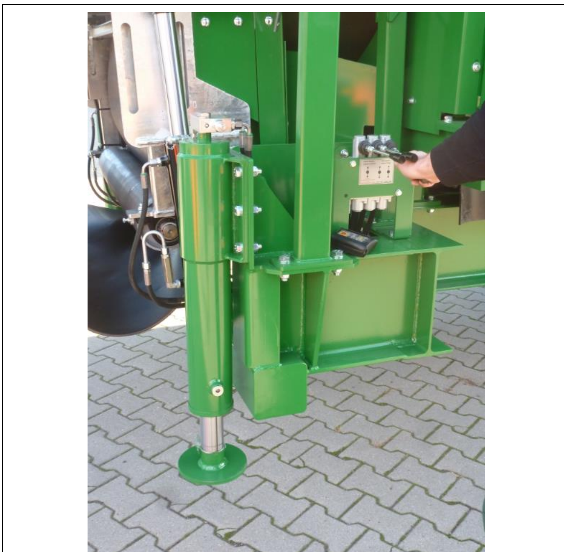
Afb. 7-1: Achterste steunpoot van de zeefinstallatie in transportstand
