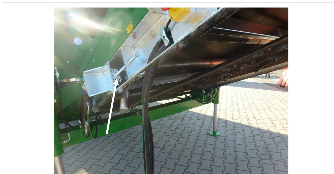
Afb. 8-7: Aanpassing van de grove fractie
