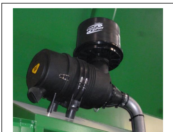
Afb. 11-6: Luchtfilter met TopSpin PreCleaner
