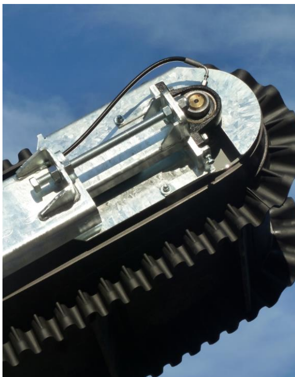
Afb. 8-8: Hoogste afstelling van de fijne fractie bij stripverlenging
