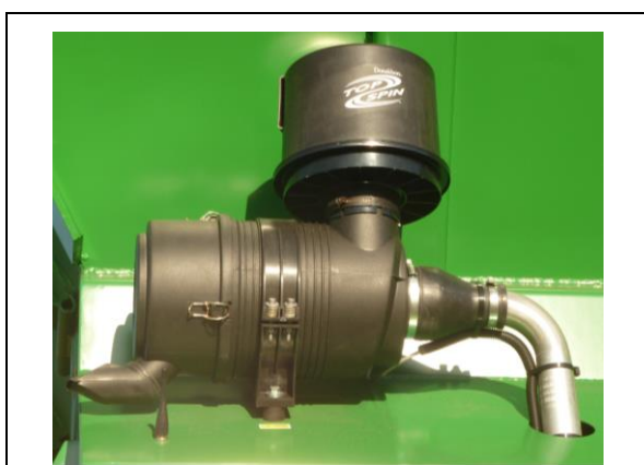
Fig. 11-6: Luftfilter med TopSpin PreCleaner
