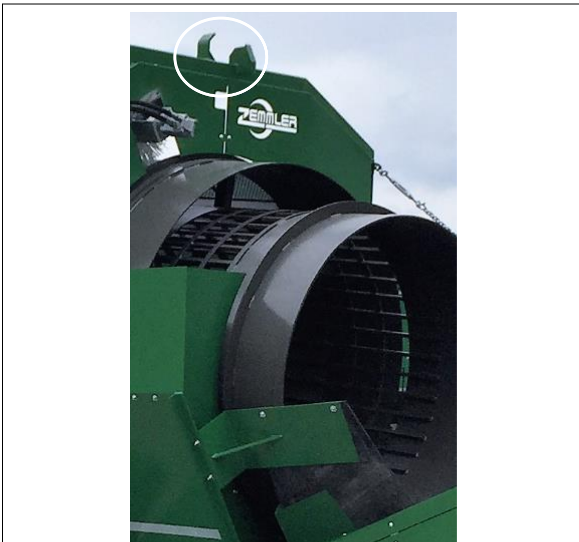
Fig. 7-5: Den forlængede mellemsfraktions transportsikring
