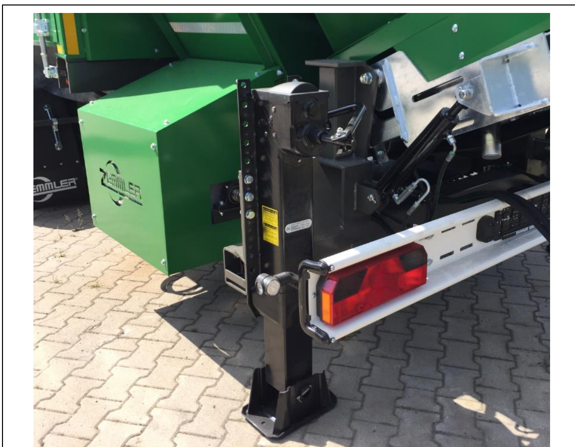
Fig. 71: Sigteanlæggets Fødebånderste støtteanordninger i arbejdsposition
