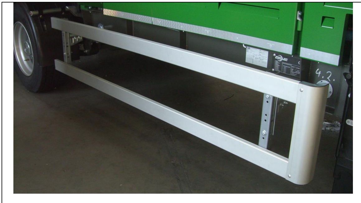
Fig. 7-7: Beskyttelsesanordning på siden
