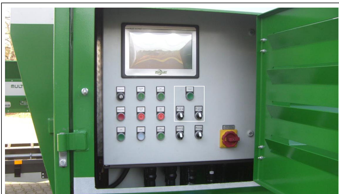
Fig. 8-2: Betjeningsenhed ind-/udklapning 1. fraktion
