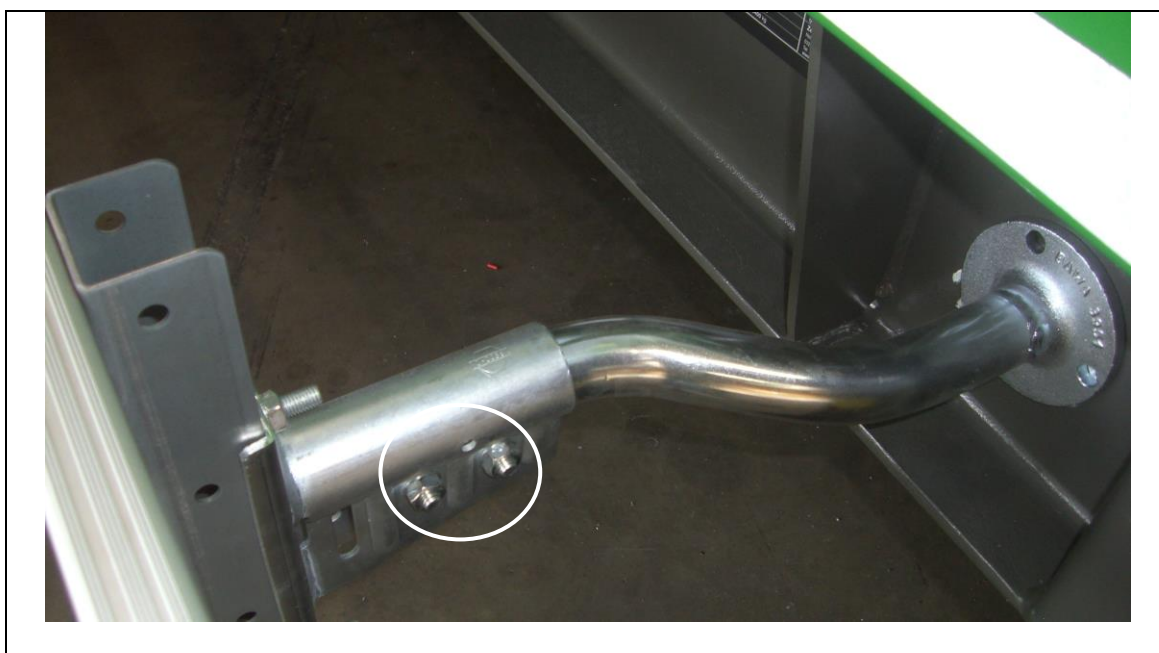
Fig. 7-8: Detalje af beskyttelsesanordning på siden
