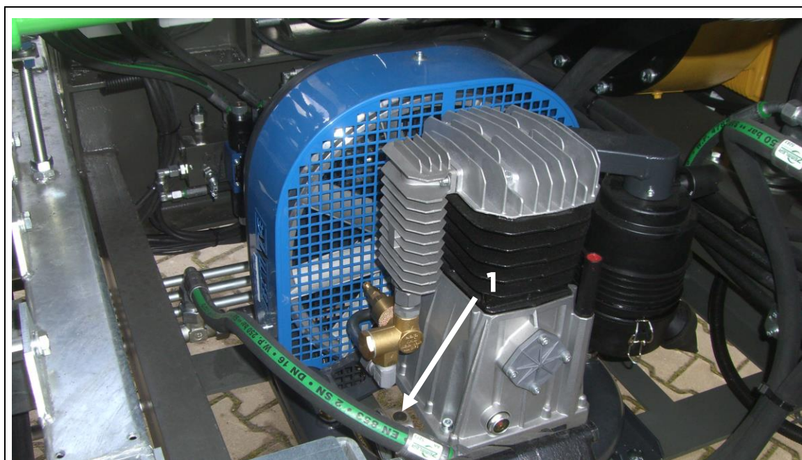
Fig. 118: Kompressor i motorrummet
