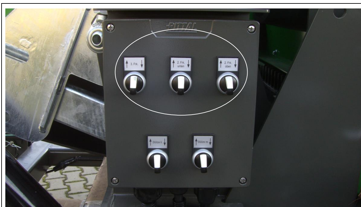
Fig. 8-3: Drejekontakt for udklapning af mellem- og grovfraktion
