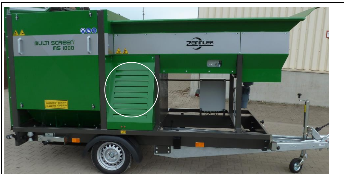
Fig. 3-3: Sikkerhedsafdækning styreruller med sikringselement
