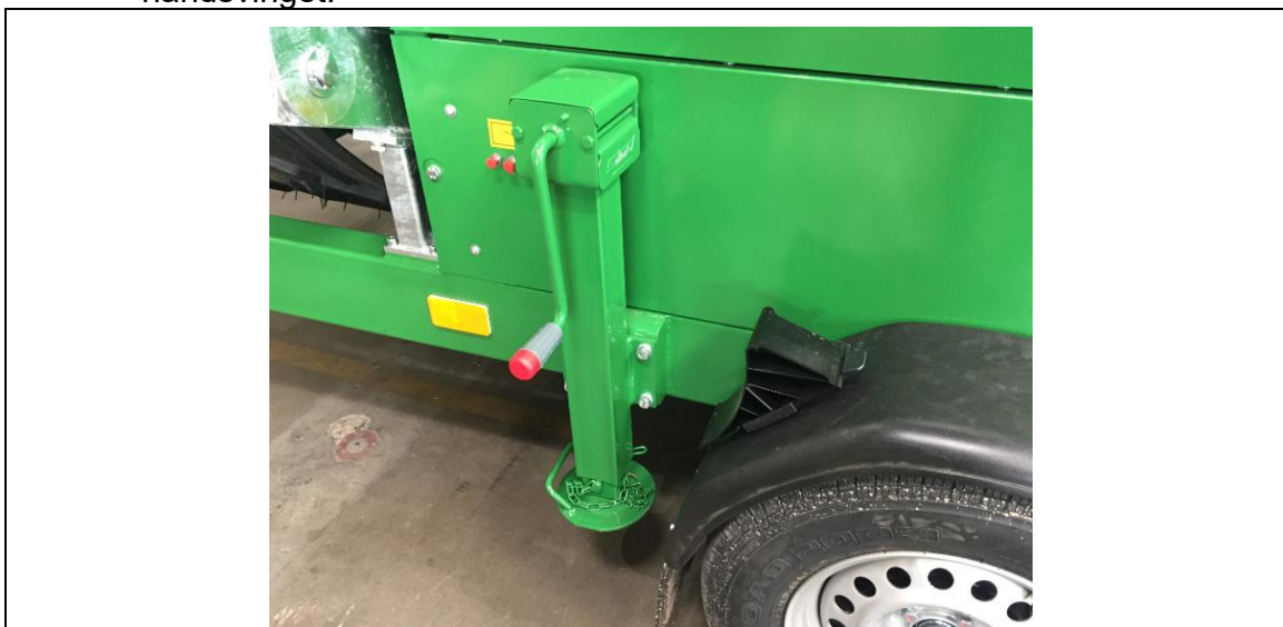
Fig. 7-1: Sianlæggets bageste støtteanordninger i transportposition
