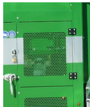
Fig. 3-3: Sikkerhedsafdækning styreruller med sikringselement
