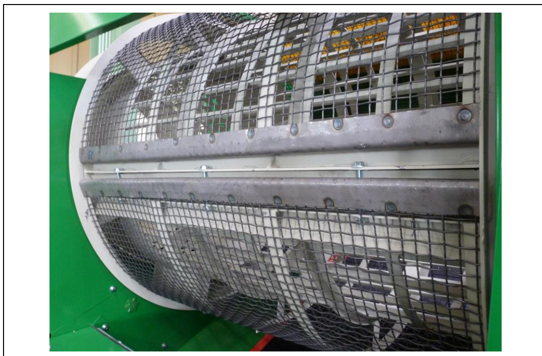
Fig. 11-3: Spændestation til udvendig si
