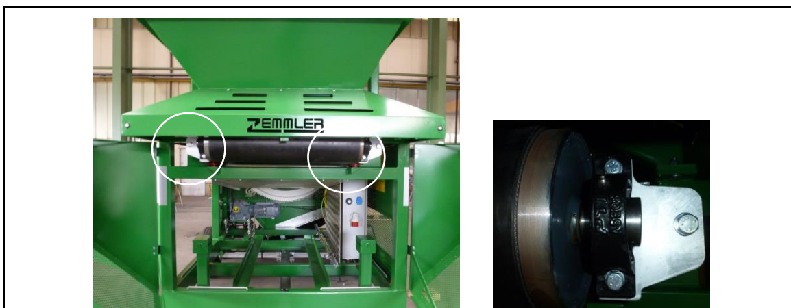
Fig. 11-8: Smørestedernes position på båndføderen
