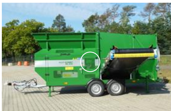
Fig. 3-3: Sikkerhedsafdækning styreruller med sikringselement
