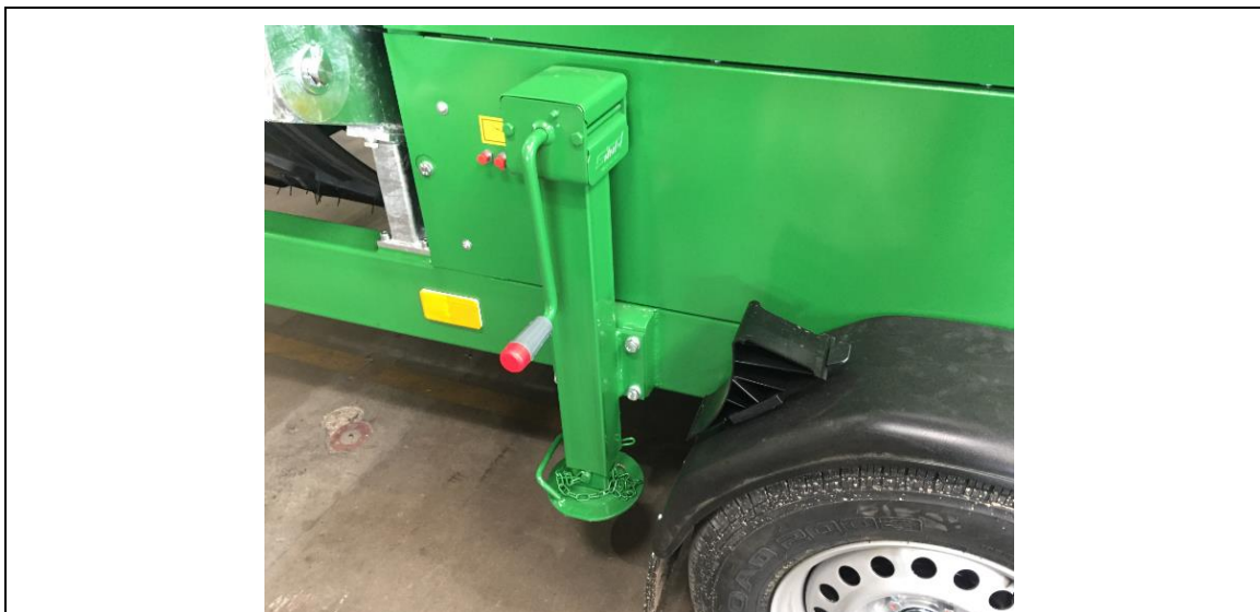
Fig. 7-1: Sianlæggets bageste støtteanordninger i transportposition
