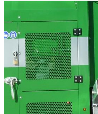
Fig. 3-3: Sikkerhedsafdækning styreruller med sikringselement
