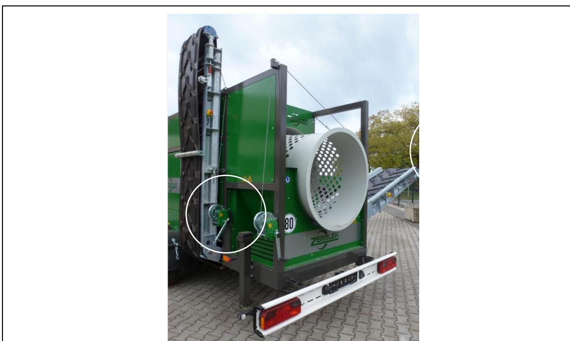
Fig. 8-2: Kabelspillet til grove fraktion
