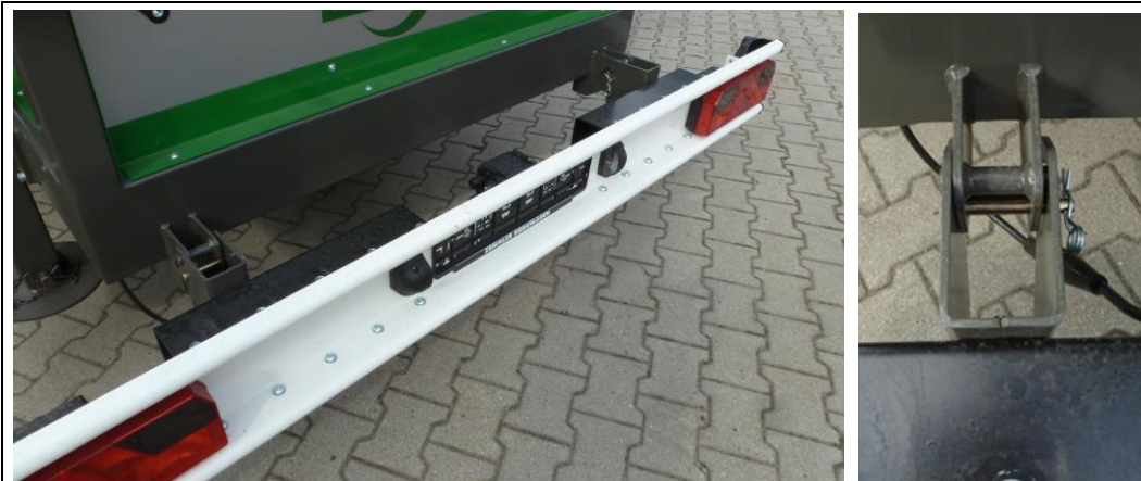
Abb. 7-2: Løsn sikringsenheden og strømforsyningen til lysstrimlen
