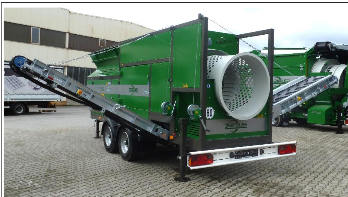
Fig. 6-2: Eksempel sianlæg i arbejdsposition (højre)
