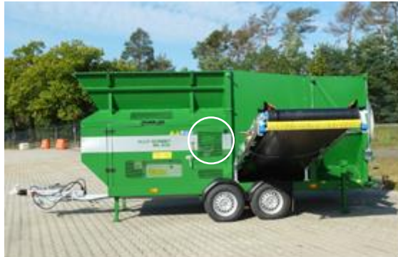
Fig. 3-3: Sikkerhedsafdækning styreruller med sikringselement
