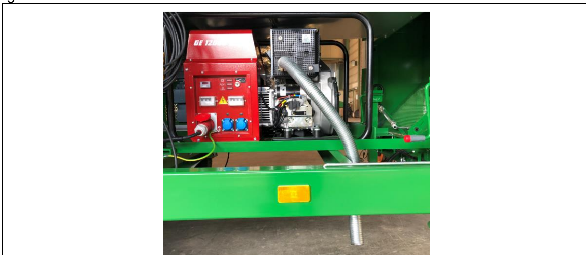
Fig. 8-3 Eksempel på lægning af udstødningsslange
