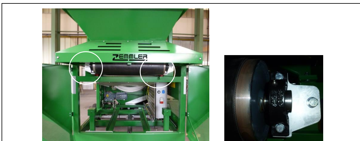
Fig. 11-9: Smørestedernes position på båndføderen
