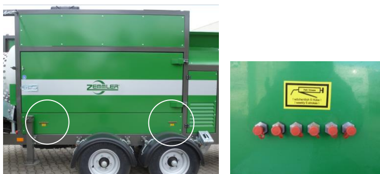
Fig. 11-9: position af de centrale smørestedernes
