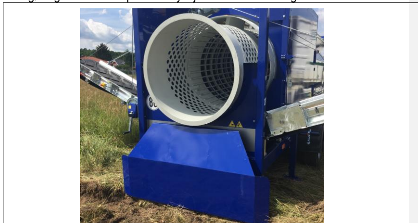
Fig. 8-4: Position af deflektorpladen
