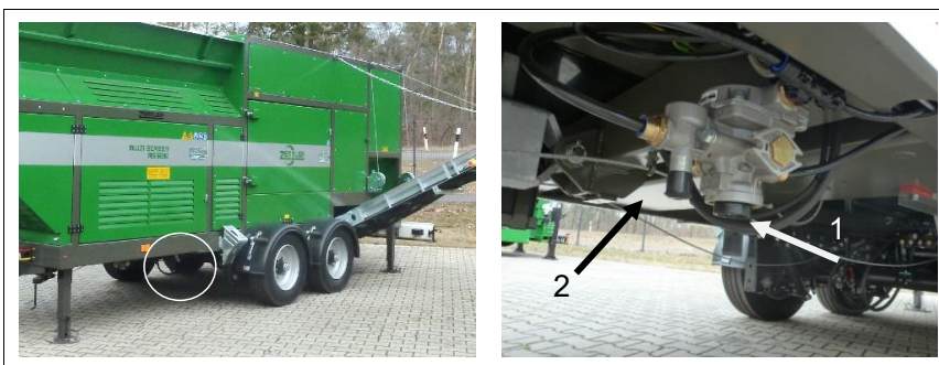
Abb. 5-1: Trailer nødventil & frigørelsesventil
