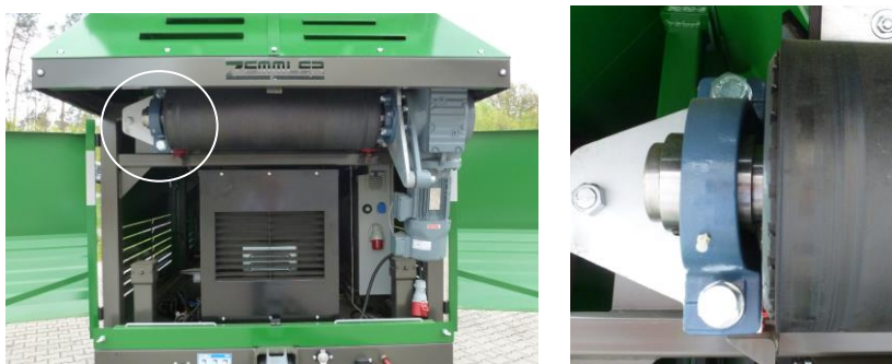
Fig. 11-10: Smørestedernes position på båndføderen
