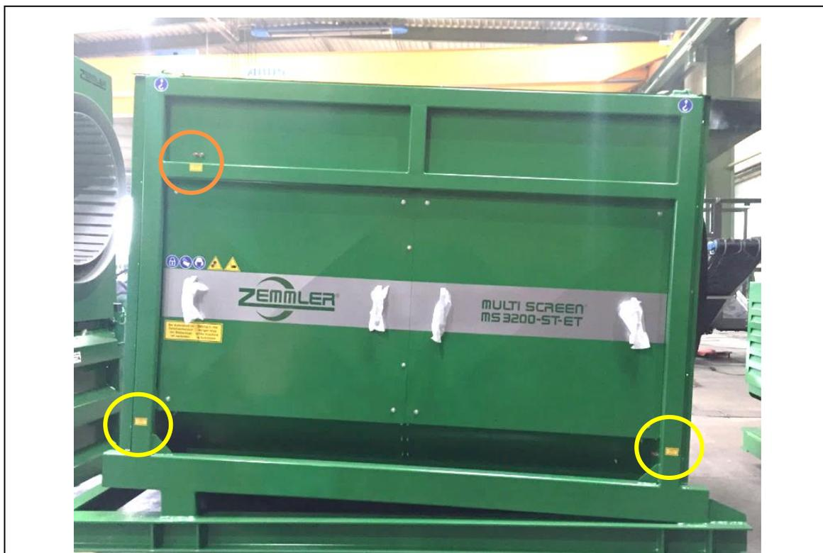
**Fig. 7-3: Posición de los puntos de lubricación centrales**
