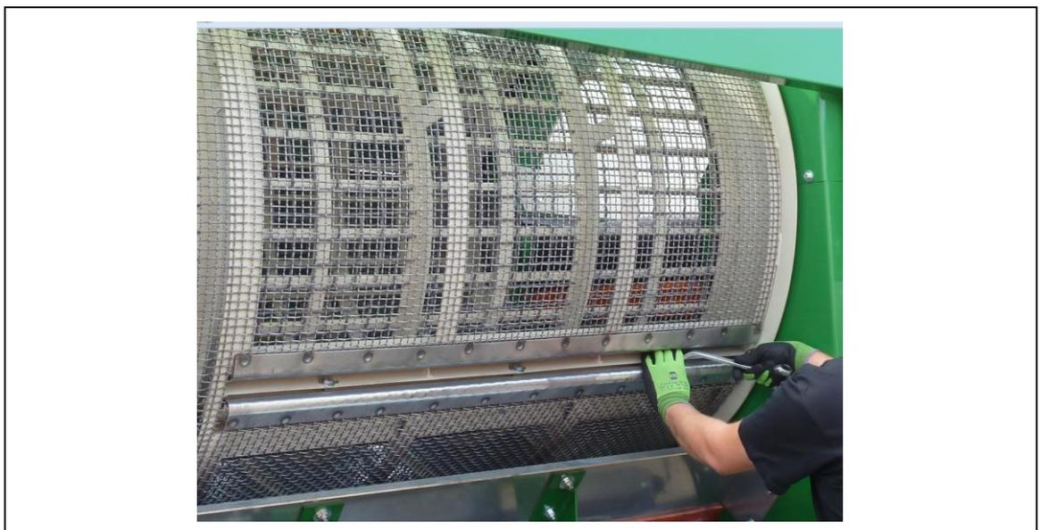
**Fig. 7-4: Dispositivo de sujeción y fijación para el tamiz (ej.)**
