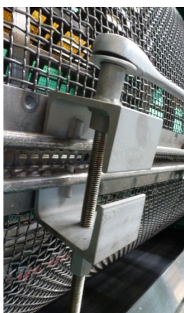
Ilustracja 84: Mocowanie sit za pomocą pomocy do napinania
