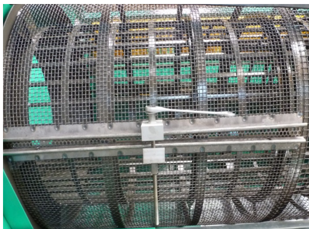
Ilustracja 84: Mocowanie sit za pomocą pomocy do napinania
