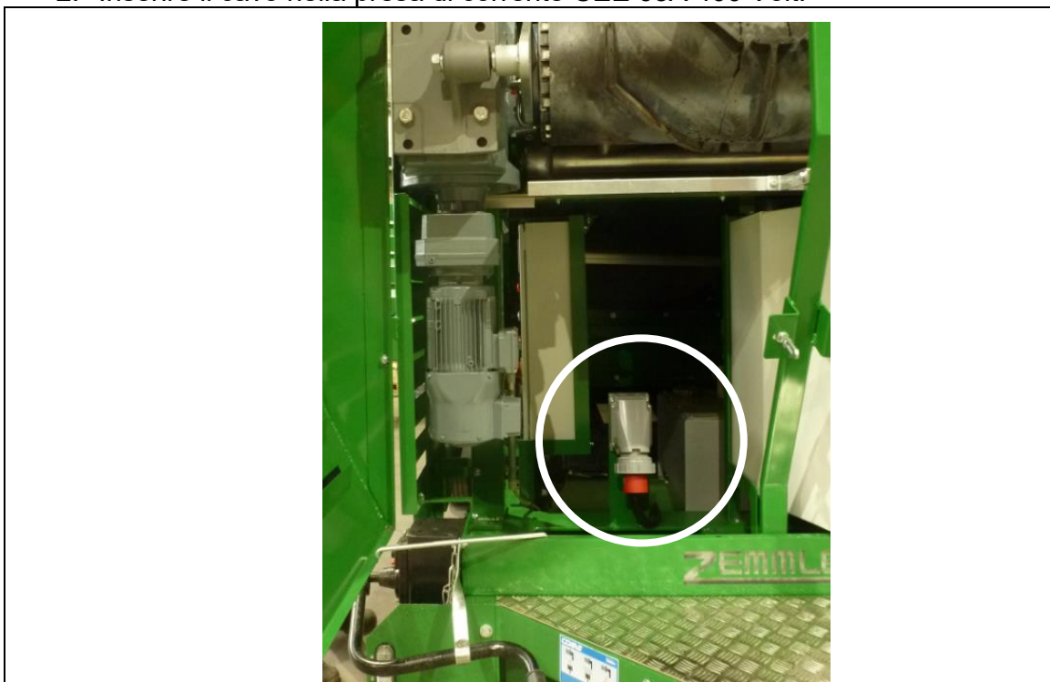
Fig. 8-1: presa di corrente
