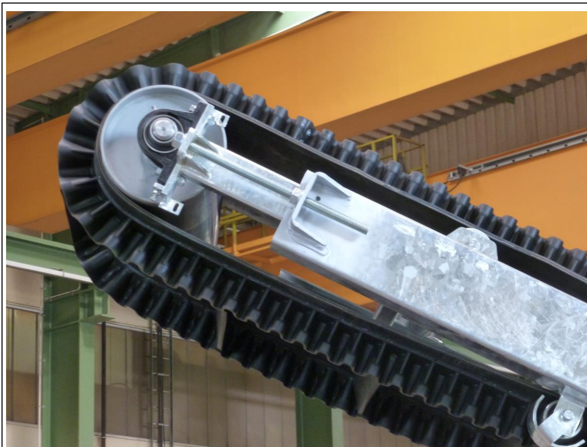
Fig. 8-10: Regolazione superiore del frazionamento fine e medio in caso di dilatazione del nastro
