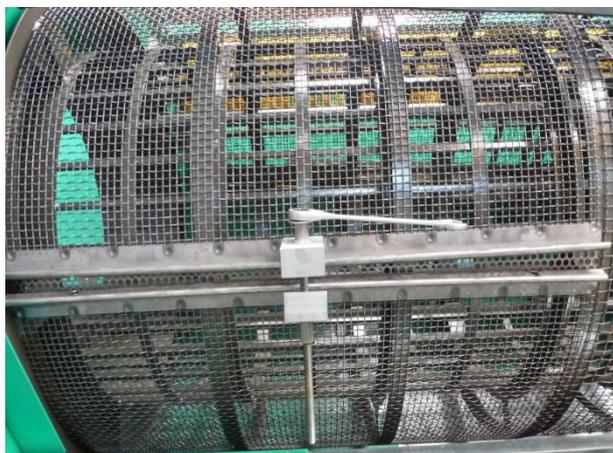
Figura 84: Bloccaggio degli schermi con l'ausilio del morsetto
