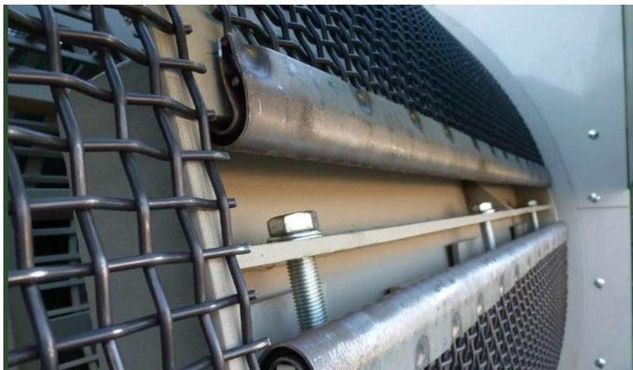
Figura 83: Elementi di bloccaggio e collegamento a vite tramite stazione di tensionamento
