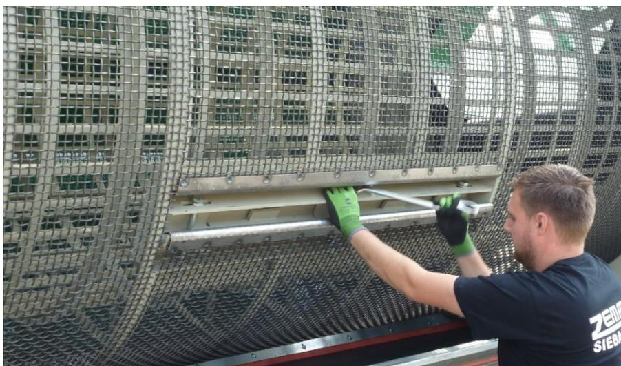
Figura 82: Bloccaggio dei setacci con la stazione di tensionamento
