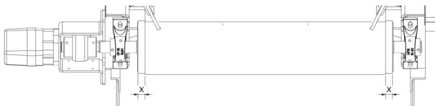
Figura 107: Distanza di tracciamento del nastro trasportatore
