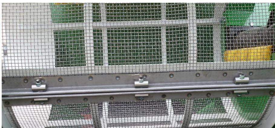
Figura 85: Elementi di serraggio e collegamento a vite senza stazione di tensionamento
