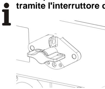
Figura 15: Interruttore di isolamento della batteria in posizione "OFF".
