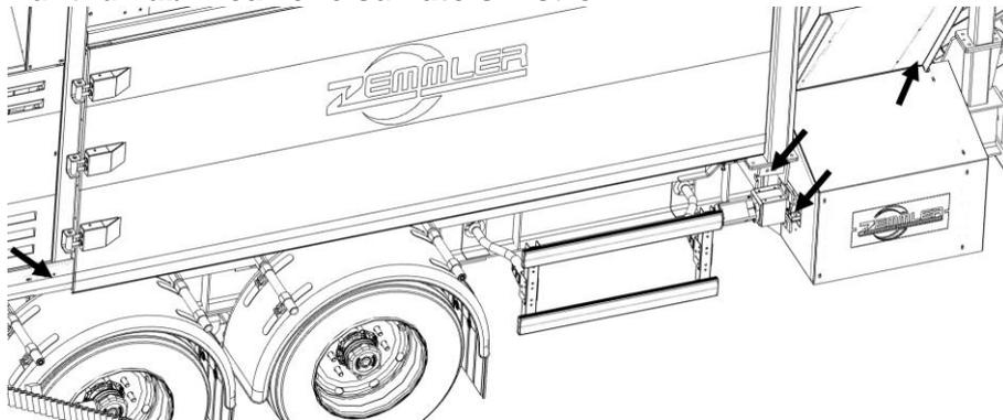
Figura 97: Posizione dei punti di lubrificazione dell'alloggiamento a sinistra (31,32,33,37,38,41,42)
