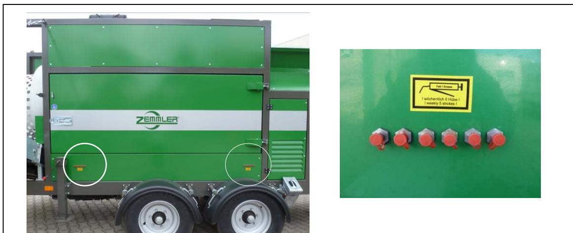
Fig. 11-9: Posizione dei punti di lubrificazione centrali
