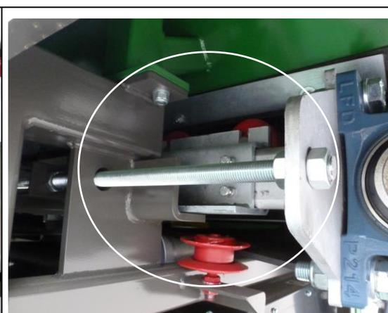
Fig. 11-8: Dispositivo di serraggio esterno
