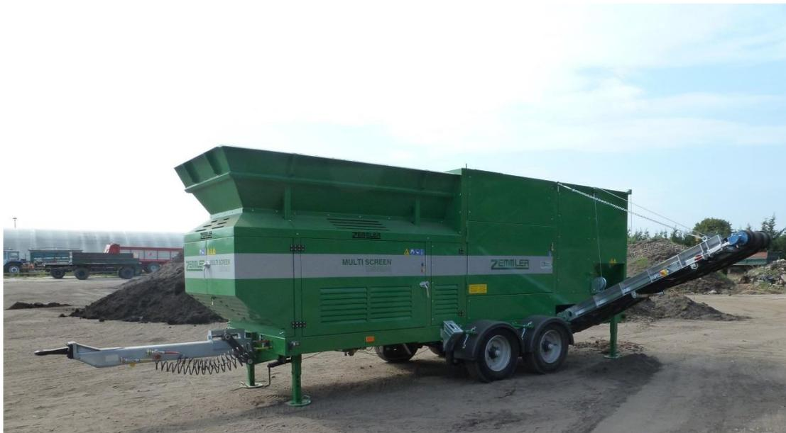
**Fig. 6-1: Esempio di impianto di vagliatura in posizione di lavoro (vista frontale da sinistra)**
