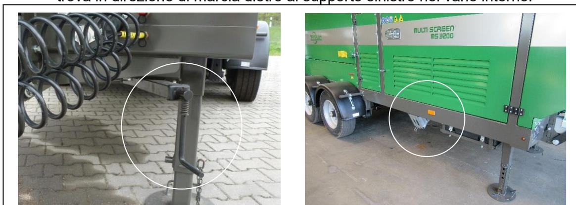
Fig. 7-1: Posizione freno di stazionamento e supporto per scarpa di arresto
