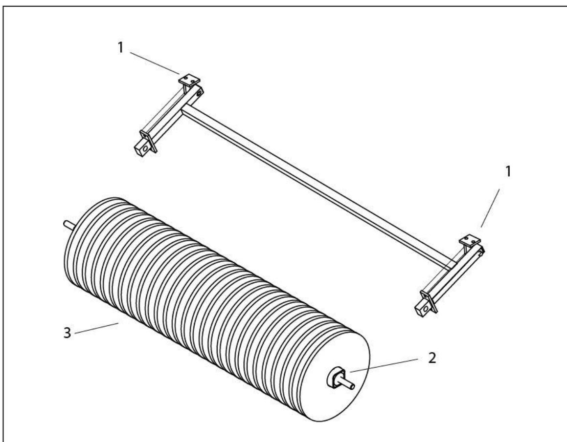
Fig. 11-6: Struttura e fissaggio degli elementi della spazzola
