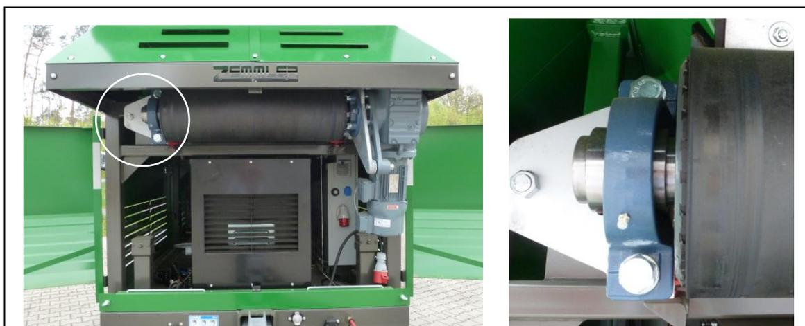
Fig. 11-10: Posizione dei punti di lubrificazione sull'alimentatore a nastro
