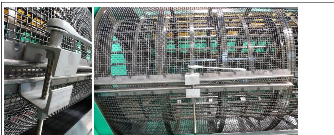
**Fig 11.4: Ausilio di serraggio**
