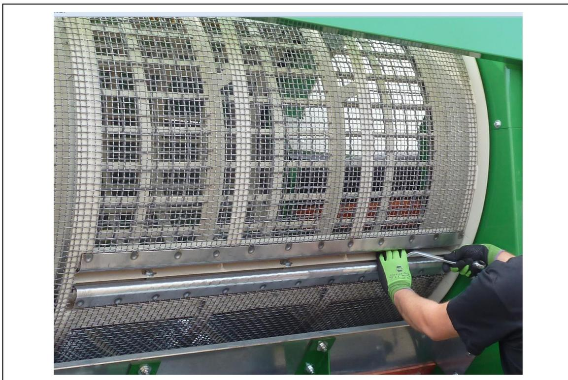
**Fig. 11-3: Stazione di tensionamento e fissaggio per la rete del vaglio (esempio)**
