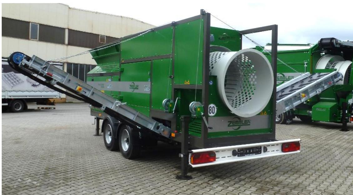
**Fig. 6-2: Esempio di impianto di vagliatura in posizione di lavoro (vista da dietro a sinistra)**
