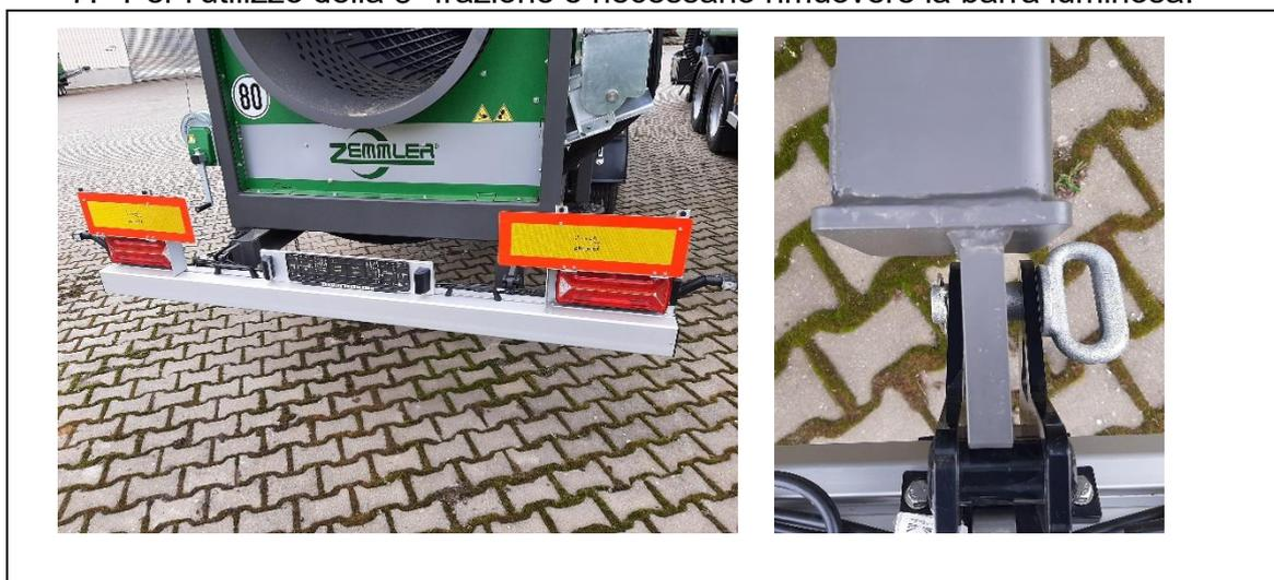
**Fig. 7-3: allentare unità di sicurezza e alimentazione di corrente della barra luminosa**
