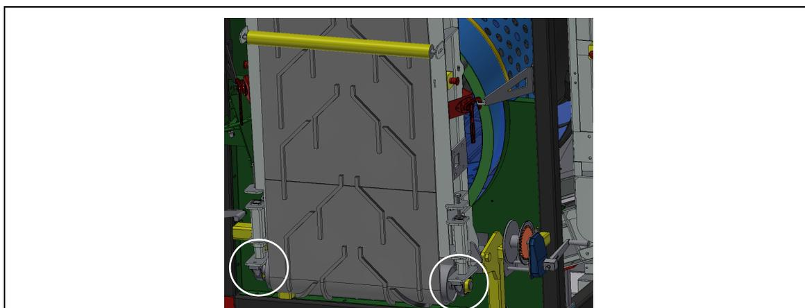
Fig. 11-11: Posizione dei punti di lubrificazione della 3a frazione (opzione)
