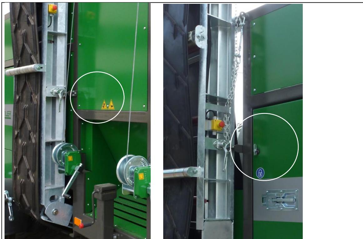
Fig. 7-4: Dispositivo di sicurezza per il trasporto - 1<sup>a</sup> e 2<sup>a</sup> frazione
