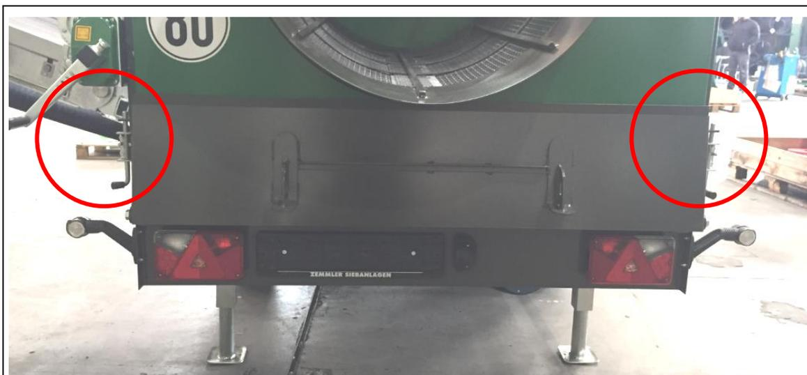
Fig. 7-2: Protezione fanale posteriore
