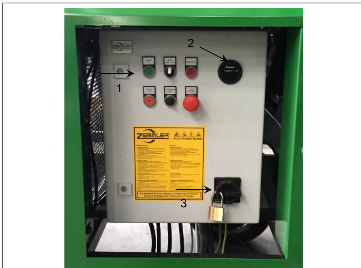
Fig. 4-2: Display operativi e di stato
