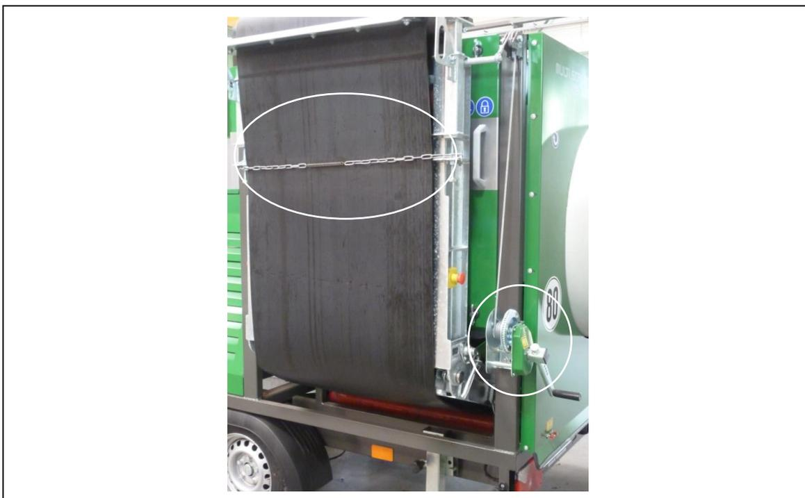
**Fig. 8-1: Blocco di sicurezza per il trasporto Frazione fine**
