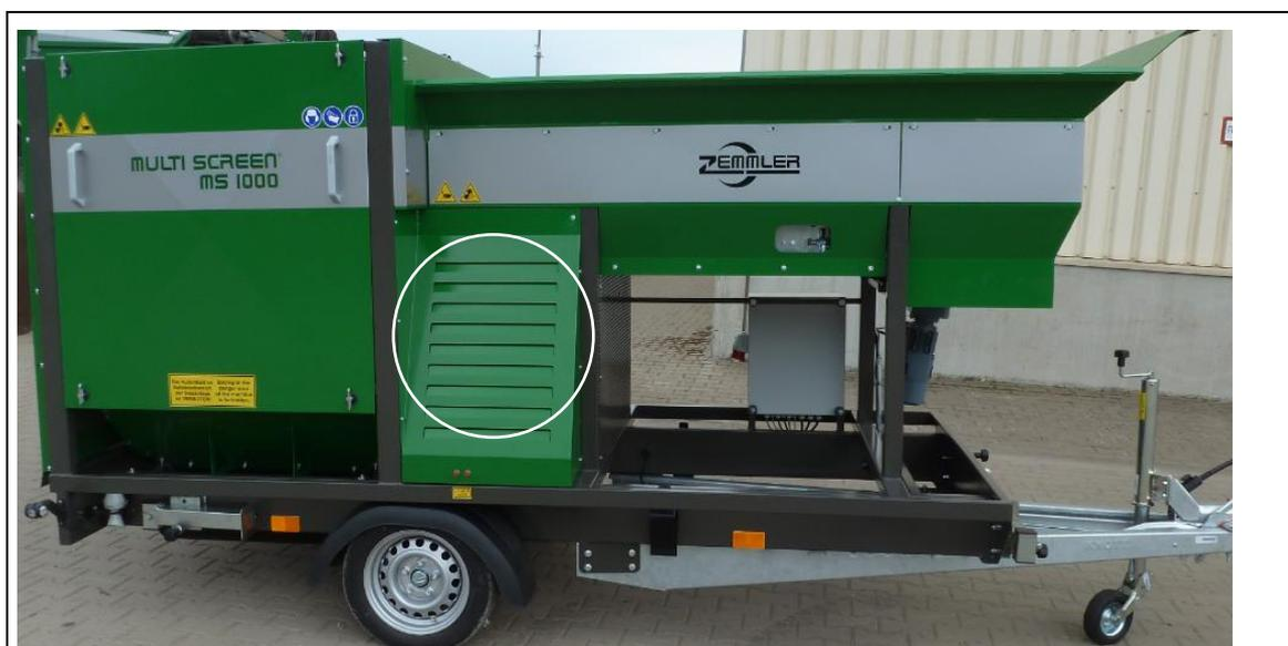
Fig. 3-3: Copertura di protezione Rulli di comando con lucchetto
