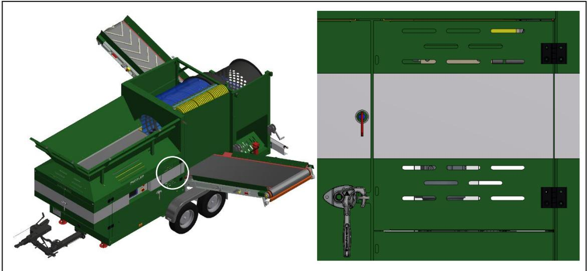
**Fig. 3-3: Coperture di protezione - rulli di controllo con lucchetto**
