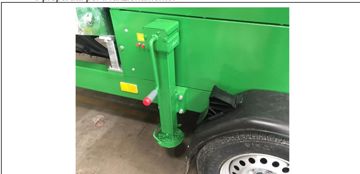
Fig. 7-1: Supporto posteriore dell'impianto di vagliatura in posizione di trasporto
