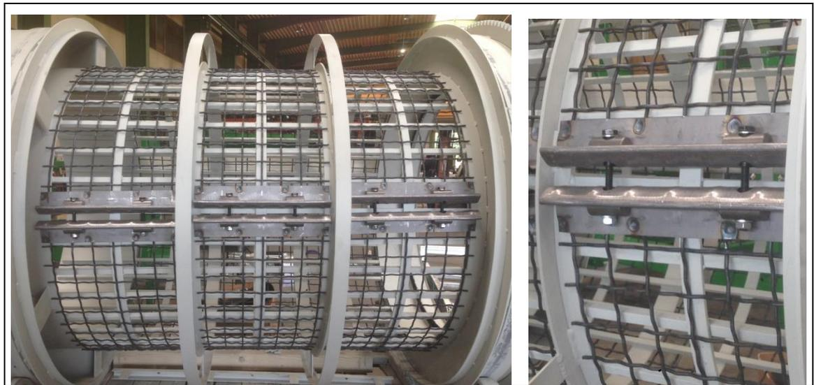
**Fig. 11-5: Dispositivo di tensionamento per il vaglio interno**
