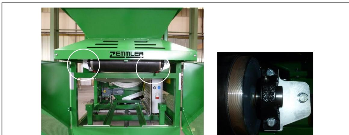
Fig. 11-9: Posizione dei punti di lubrificazione sull'alimentatore a nastro
