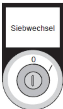
Attivare la sostituzione del vaglio con l'interruttore a chiave MS2 sull'unità di controllo. Posizionare l'interruttore a chiave su „I“.
