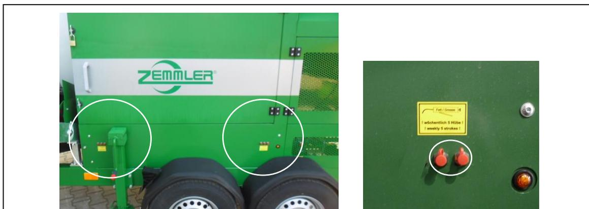
Fig. 11-7: Posizione dei punti di lubrificazione dei rulli portanti
