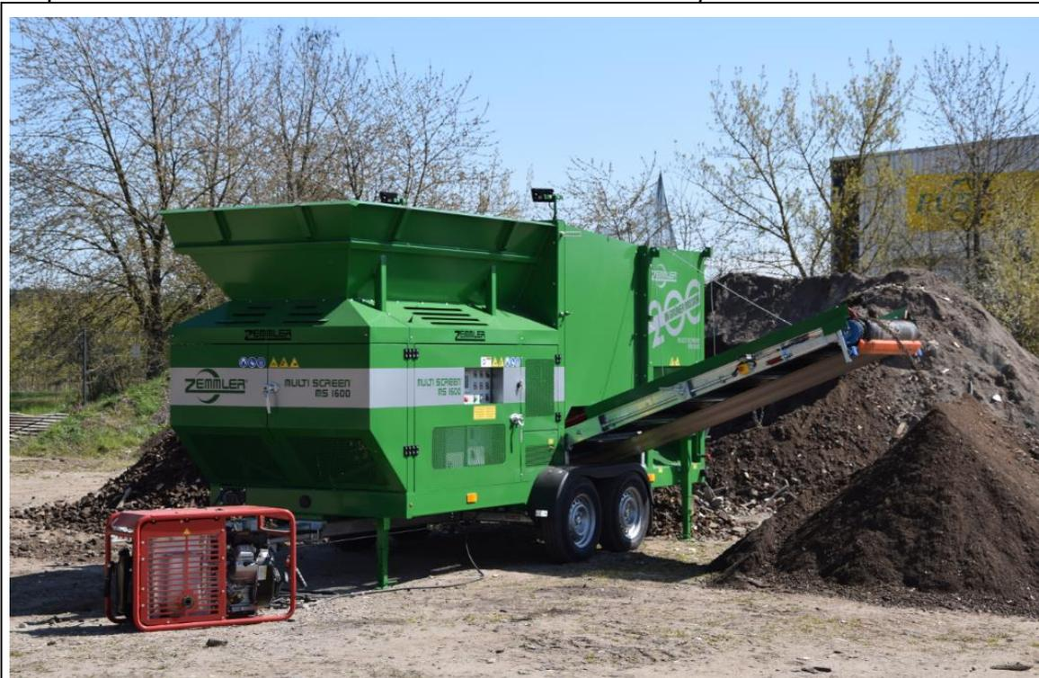
Fig. 6-1: Esempio di impianto di vagliatura in posizione di lavoro (vista frontale da sinistra)
