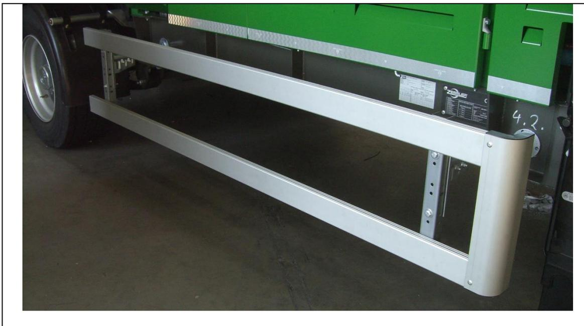
Fig. 7-9: Dispositivo de protección lateral
