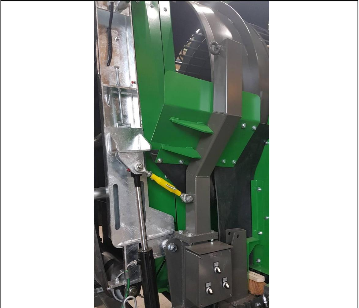
Fig. 7-7: Seguro de transporte fracción gruesa
