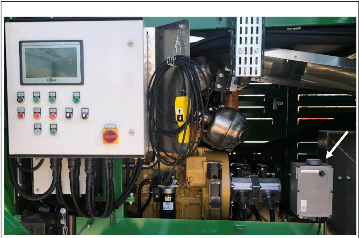
**Fig. 11-7: Unidad de control de ventilador reversible posicionada junto al armario de distribución**
