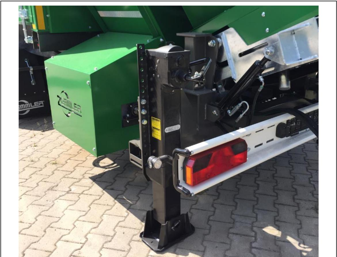
**Fig. 7-1: Dispositivos de apoyo traseros de la planta de cribado en posición de trabajo**
