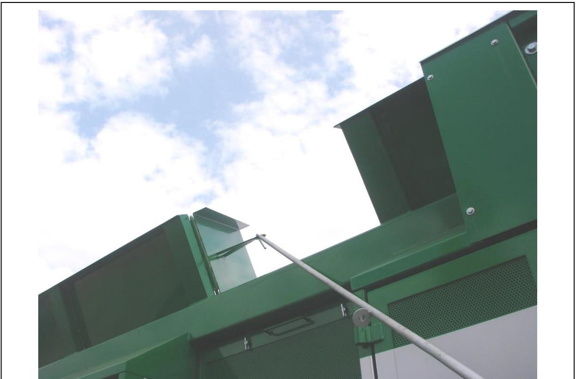
Fig. 8-4: Barra de gancho y argolla de la puerta de servicio
