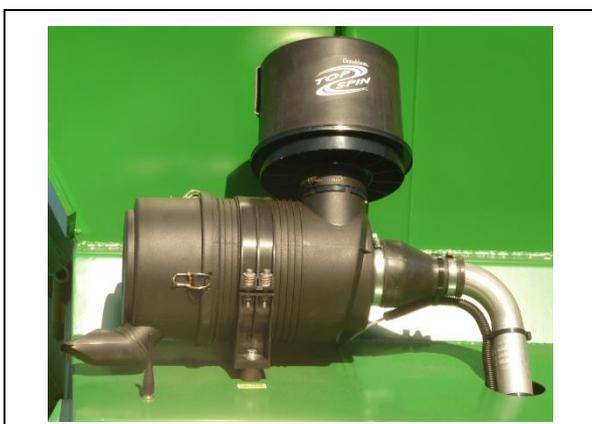
**Fig. 11-6: Filtro de aire con TopSpin
