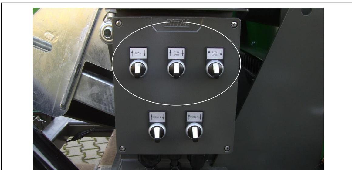
**Fig. 8-3: Interruptor de palanca para repilegue/despliegue de la fracción media y de la fracción gruesa**
