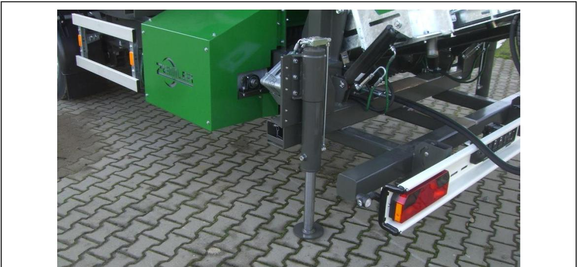
**Fig. 7-2: Apoyos hidráulicos traseros de la planta de cribado en posición de trabajo**
