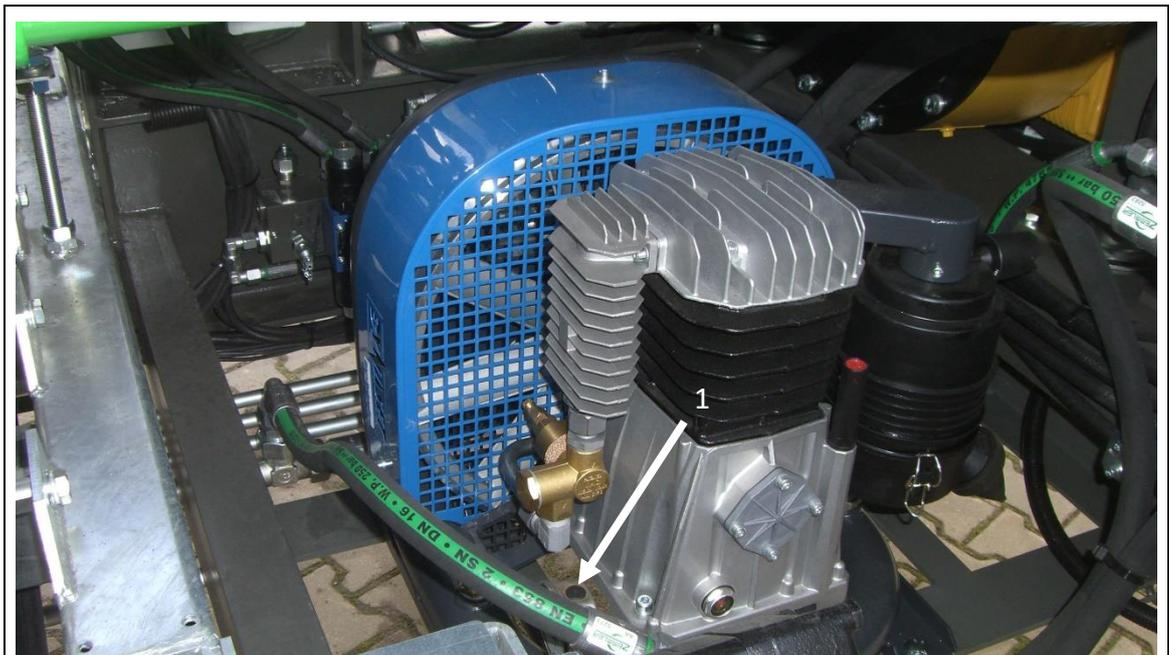
Fig. 11-8: Compresor en el compartimento interior de motor
