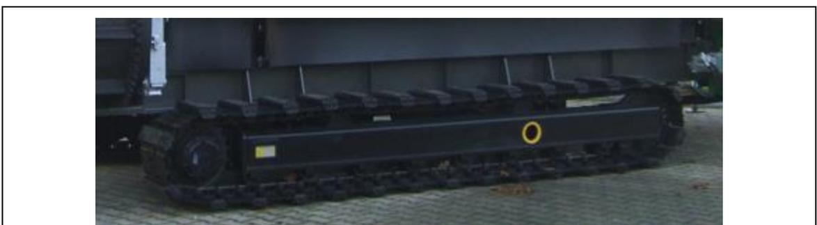
Fig. 5-3. Tren de rodaje de oruga
