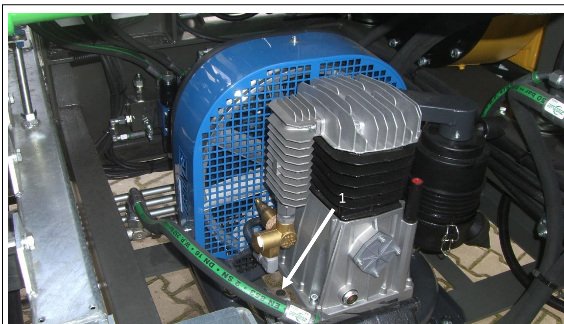
Fig. 11-8: Compresor en el compartimento interior de motor
