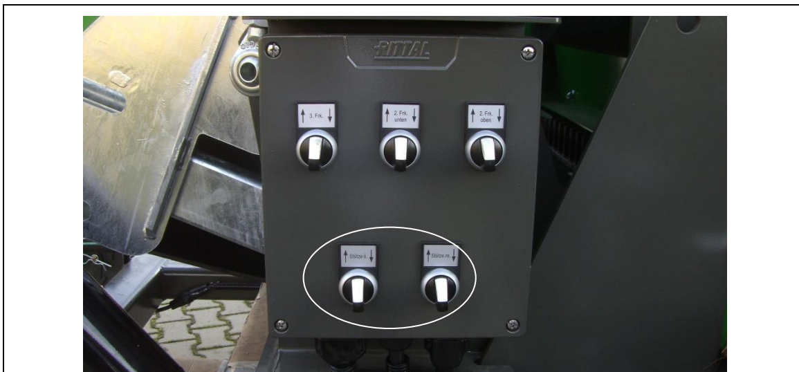
Fig. 7-3: Caja de conexiones con interruptores de palanca para los apoyos hidráulicos traseros
