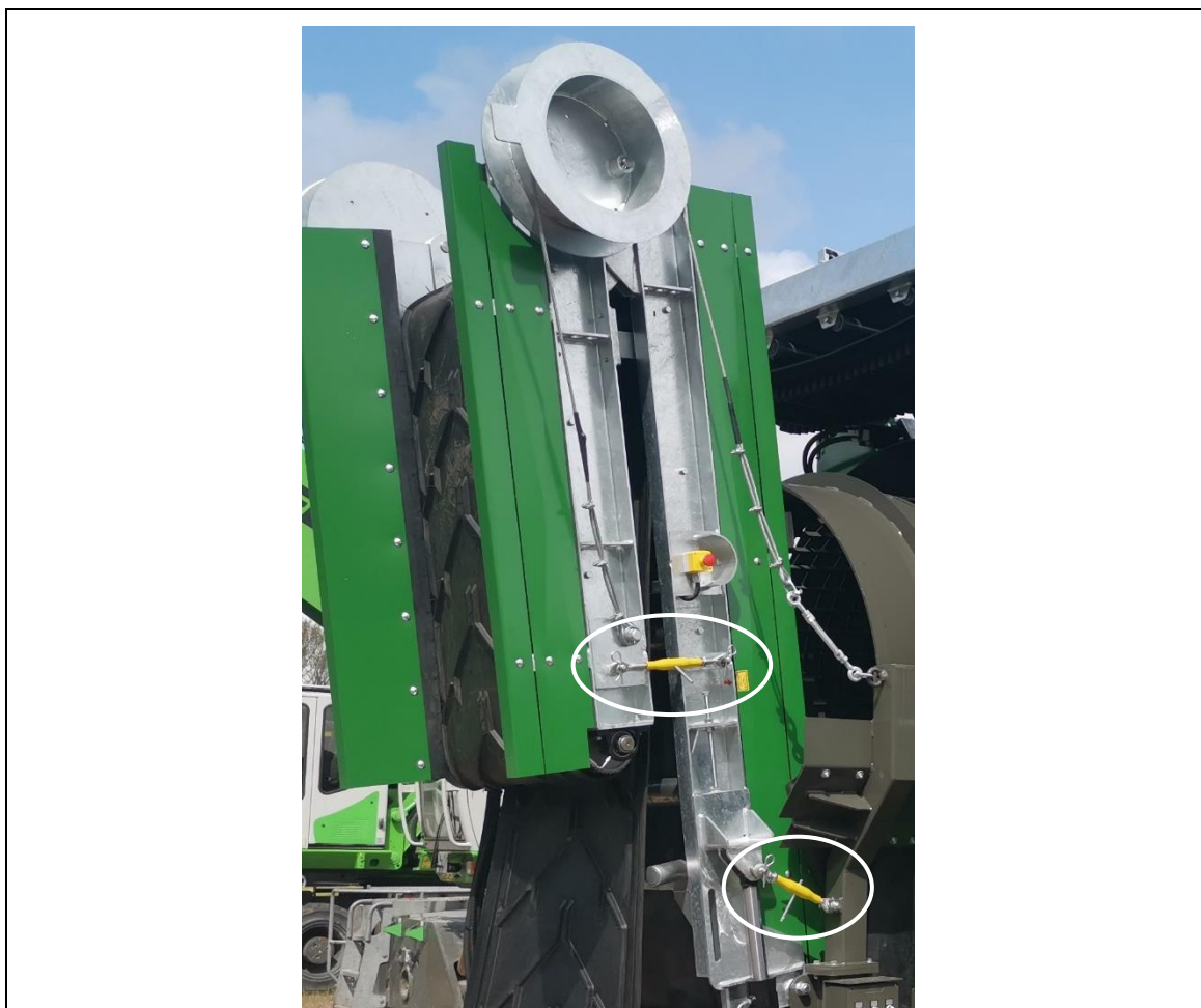
Fig. 7-8: Seguro de transporte de la fracción gruesa prolongada
