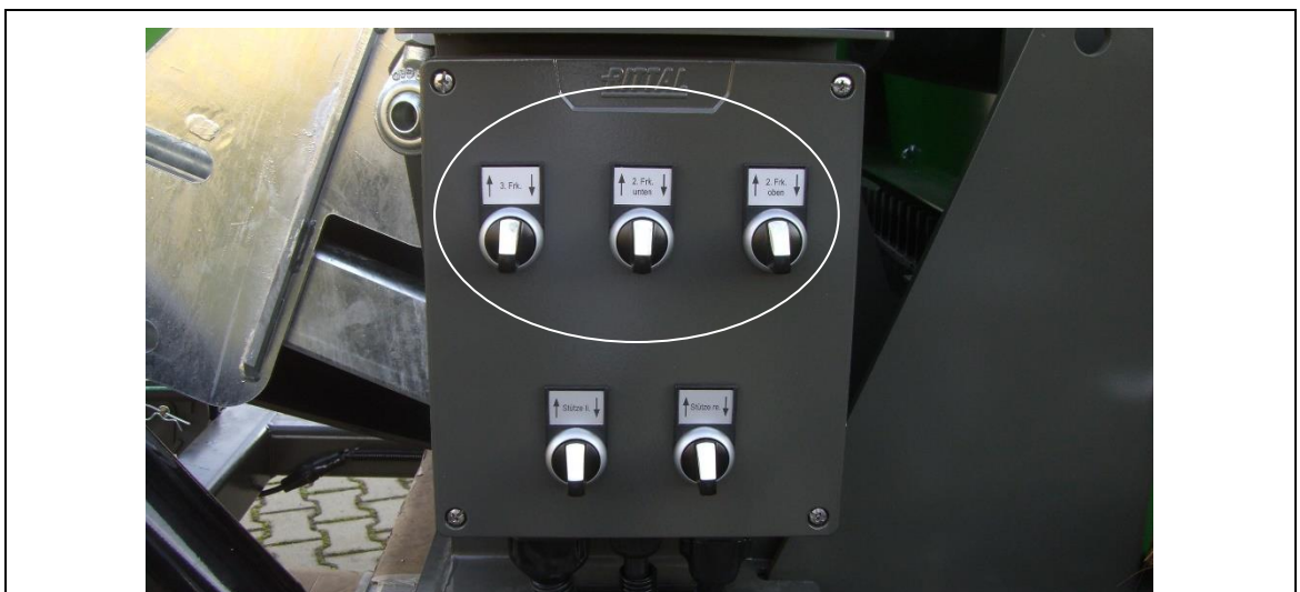
Fig. 8-3: Interruptor de palanca para repilegue/despliegue de la fracción media y de la fracción gruesa
