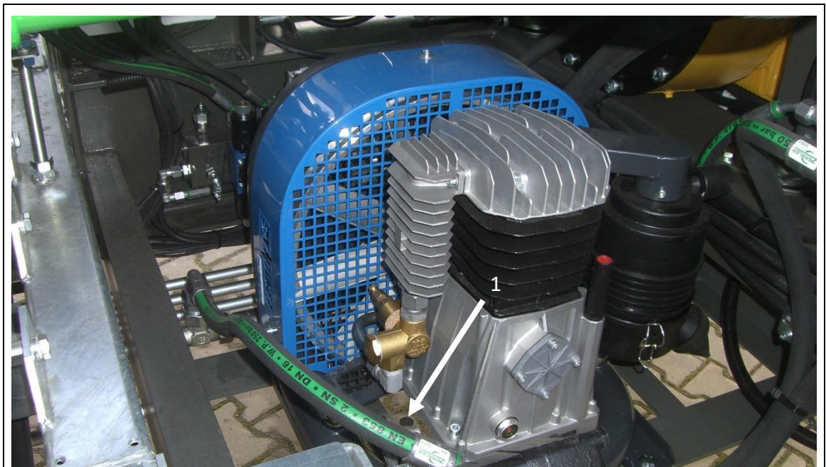
Fig. 11-8: Compresor en el compartimento interior de motor
