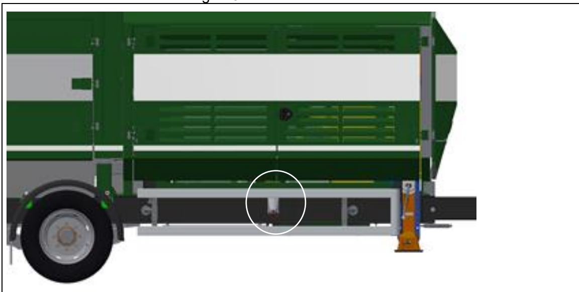
Fig. 4-2: Conexión de red fija de 400V toma de corriente CEE63A
