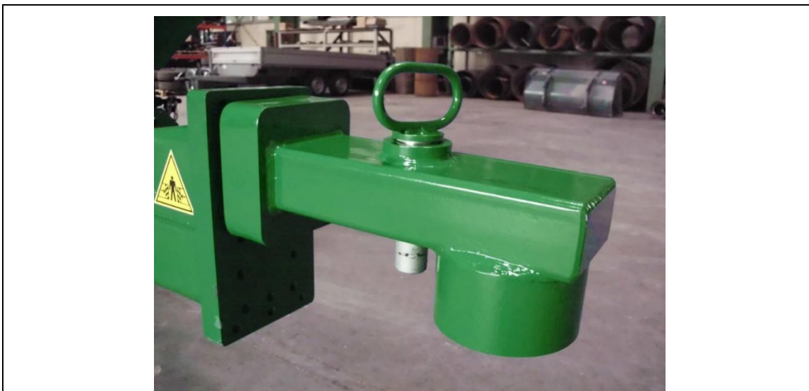
Fig. 5-2. Calce de inserción colocado
