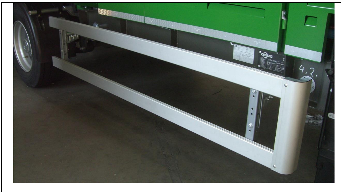
Fig. 7-9: Dispositivo de protección lateral
