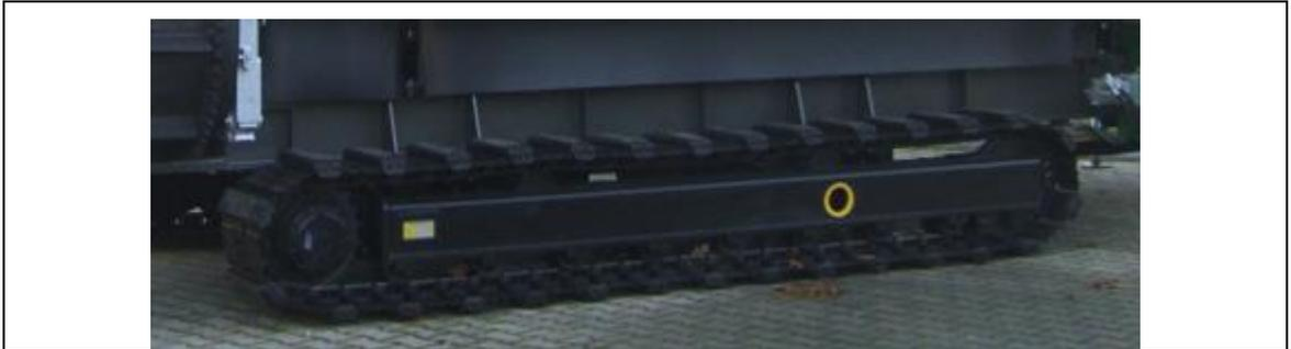
Fig. 5-1. Tren de rodaje de oruga
