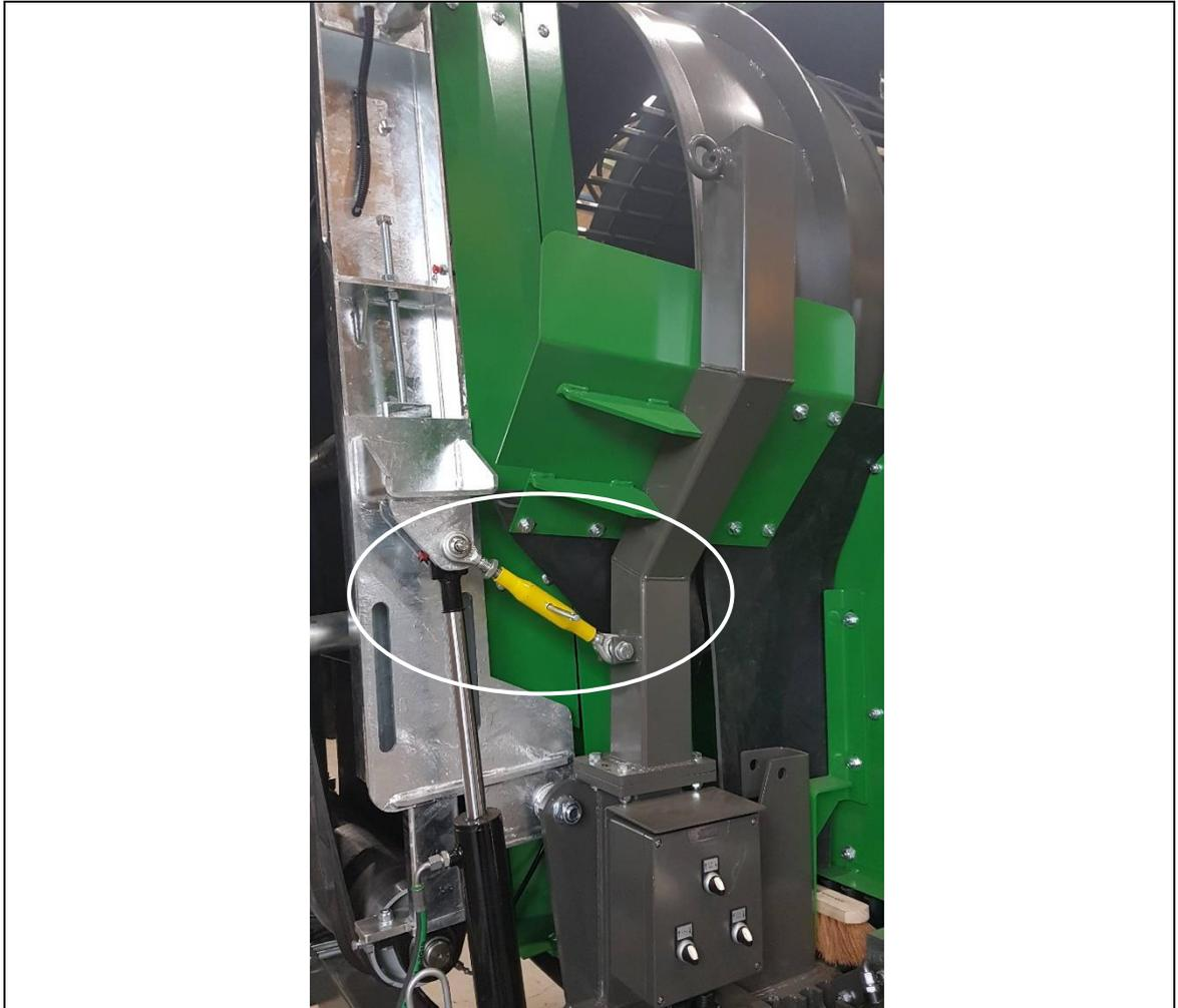
Fig. 7-7: Seguro de transporte fracción gruesa
