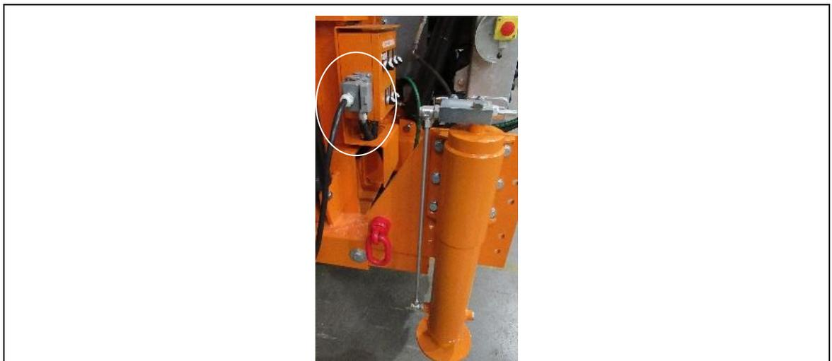
Fig. 5-2: Conexión del cable de control remoto
