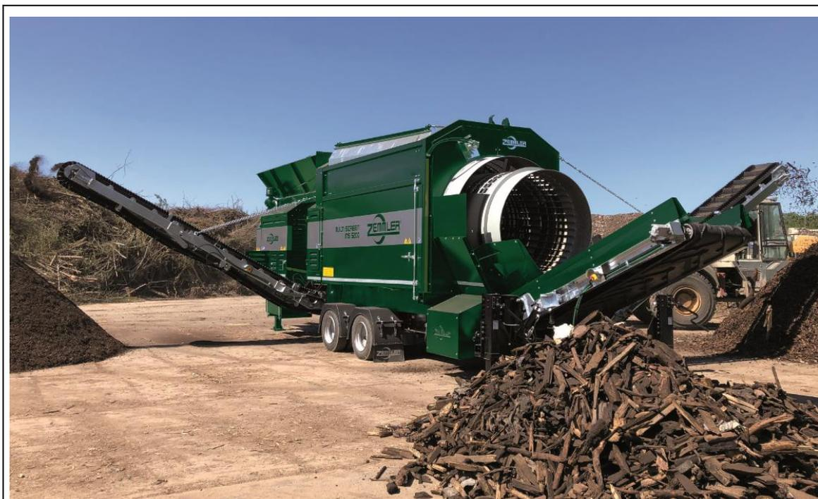
**Fig. 6-1: Ejemplo planta decridado en posición de trabajo (vista desde la parte trasera izquierda)**
