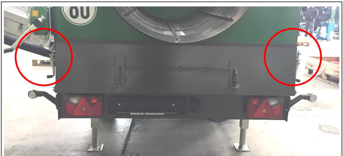
Fig. 7-2: Protección de la luz trasera
