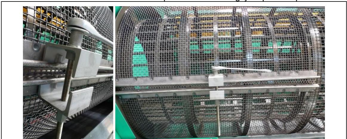
**Fig. 11.3: Ayuda para el tensado**
