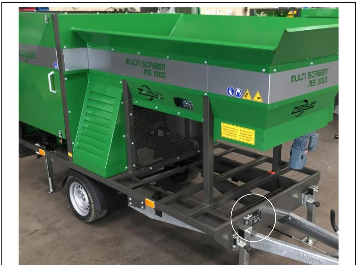
**Fig. 12-3: Placa de características delante en el sentido de marcha a la derecha (ejemplo)**
