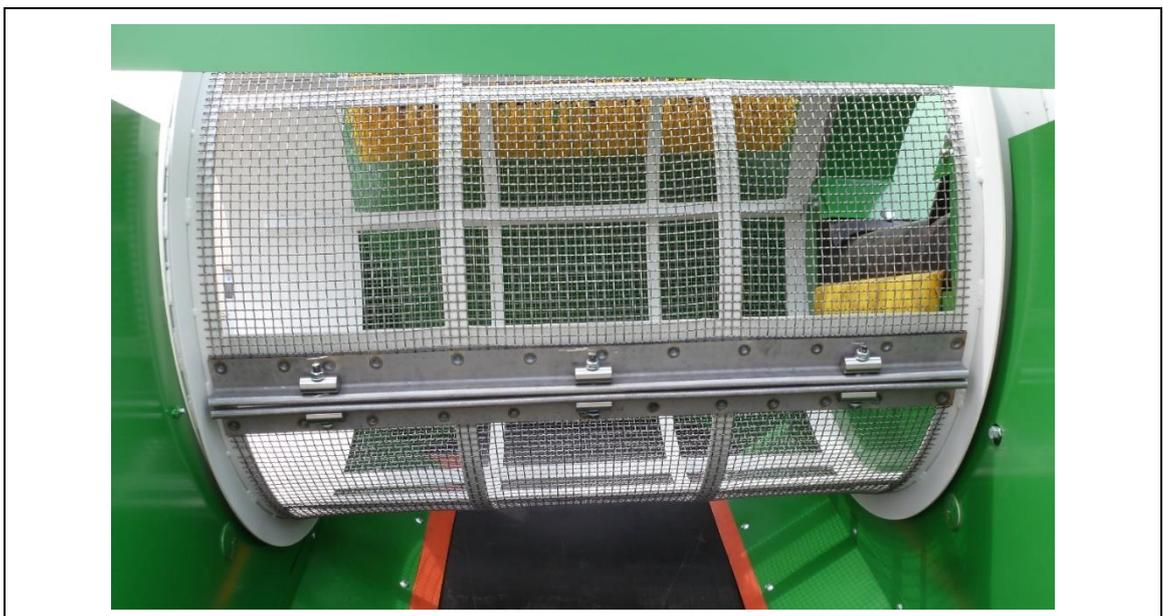
Fig. 11-4: Estación de tensado de la criba exterior
