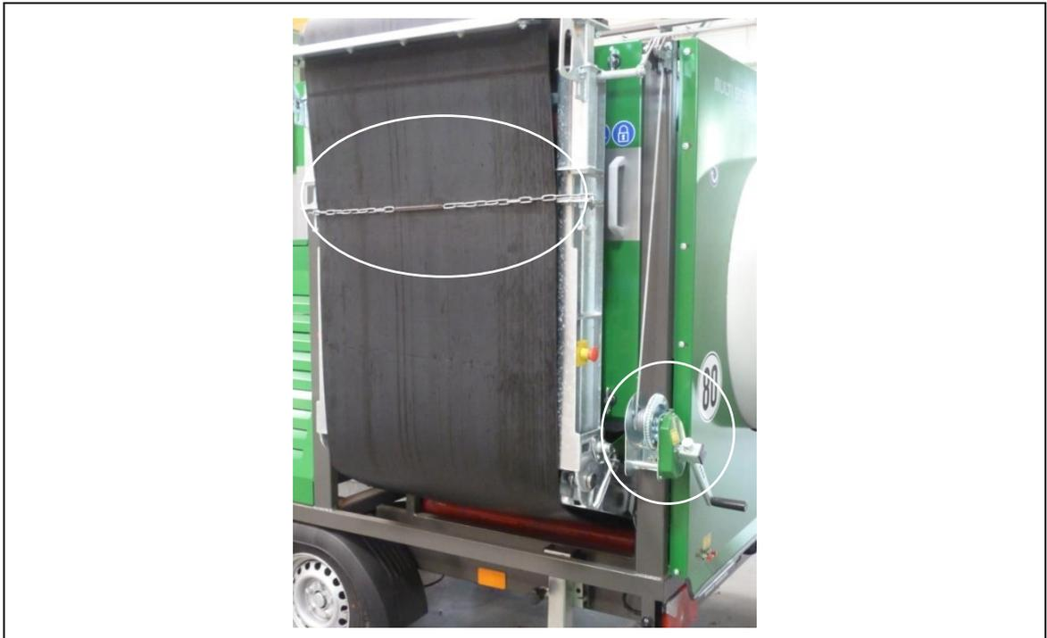
**Fig. 8-1: Seguro de transporte de la fracción fina**
