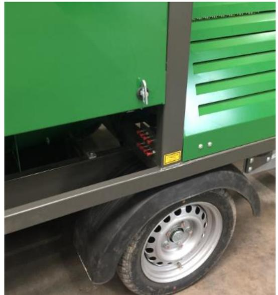
Los puntos de engrase de los cojinetes en el motor del tambor de fracción fina se tienen que engrassar directamente en el motor.
