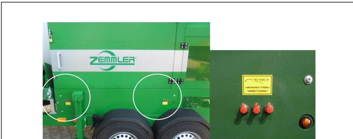
Fig. 11-7: Posición de los puntos de engrase de la fracción fina y de los rodillos portantes
