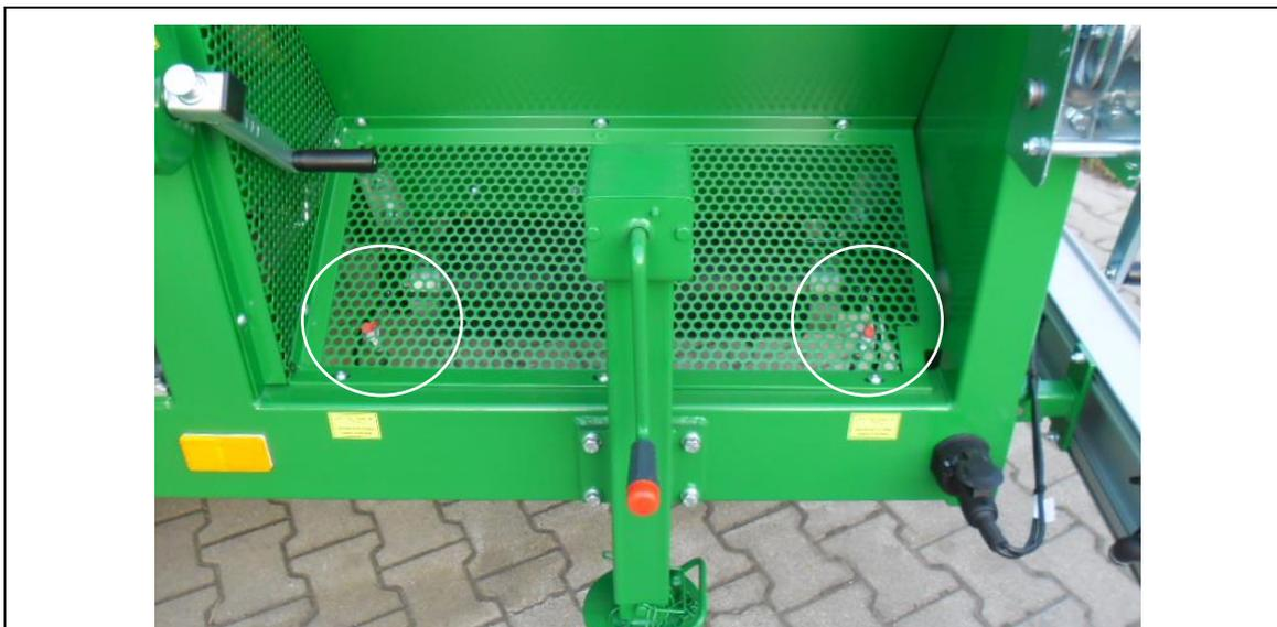
Fig. 11-8: Posición de los puntos de engrase de la fracción gruesa
