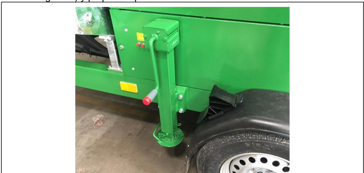
Fig. 7-1: Apoyos traseros de la planta de cribado en posición de transporte
