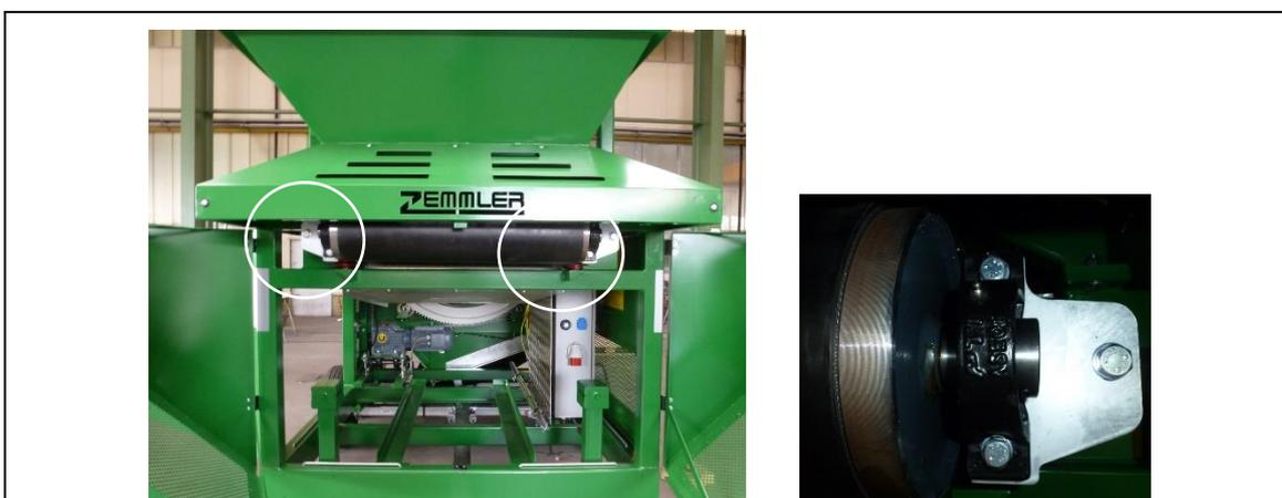
Fig. 11-9: Posición de los puntos de engrase en el alimentador de cinta
