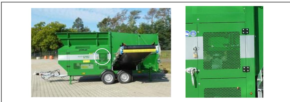
**Fig. 3-3: Protección contra atrapamiento rodillos de control con elemento de seguridad**
