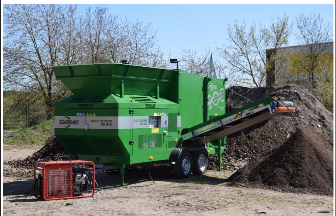
Fig. 6-1: Ejemplo planta de cribado en posición de trabajo (vista desde la parte delantera izquierda)
