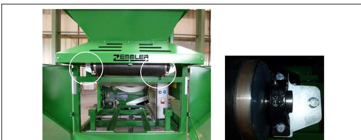
Fig. 11-9: Posição dos pontos de lubrificação no alimentador de correia
