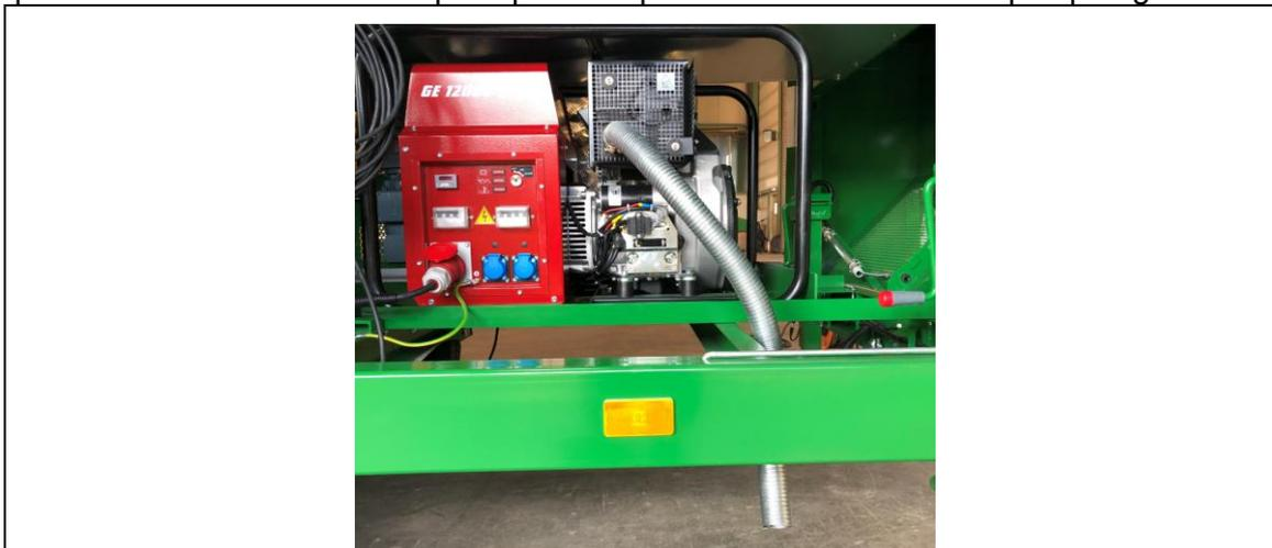
Fig. 8-3 Exemplo de colocação da mangueira de gases de escape
