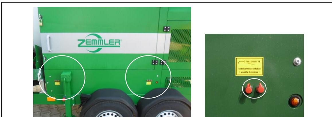
Fig. 11-7: Posição dos pontos de lubrificação das polias
