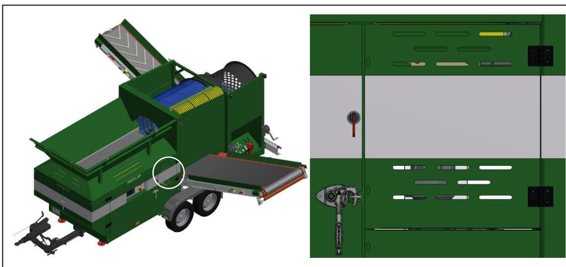
**Fig. 3-3: Proteção contra intervenção rolo de controle com elemento de segurança**
