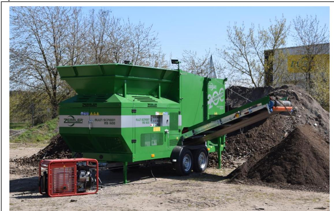
Fig. 6-1: Exemplo de equipamento de peneiramento na posição de trabalho
