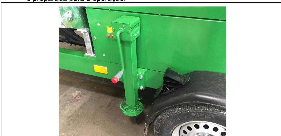
Fig. 7-1: Suporte traseiro da unidade de peneiramento na posição de transporte
