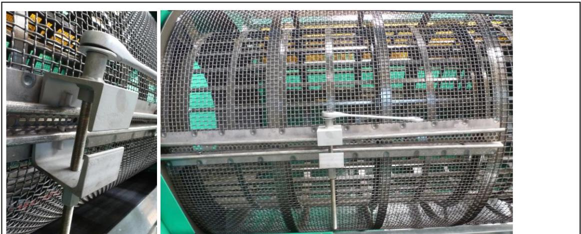
**Abb 11.4: Auxiliar de fixação**
