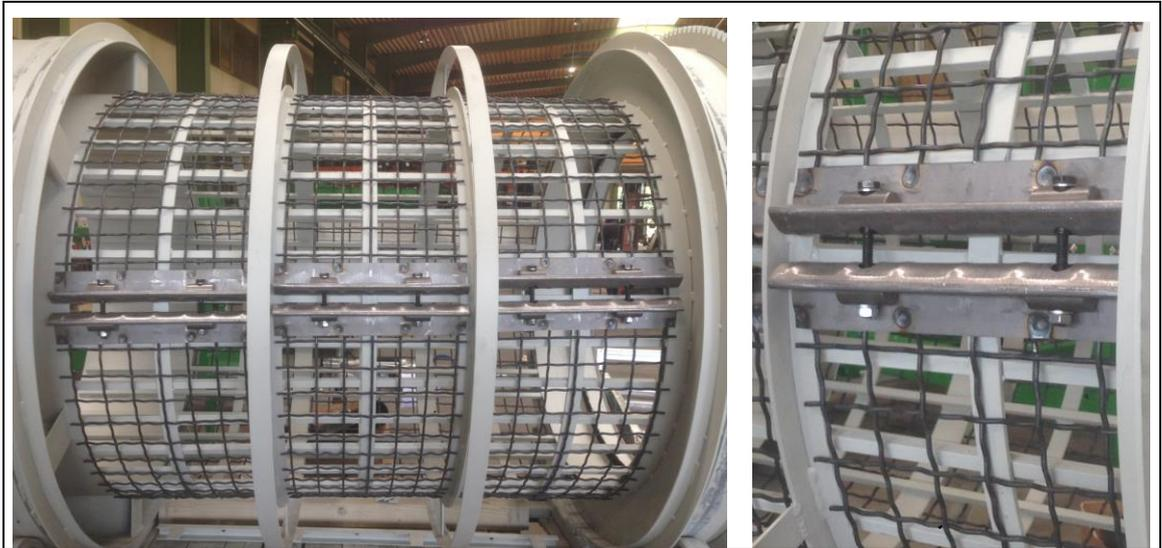
**Fig. 11-5: Dispositivo de esticamento da peneira interna**
