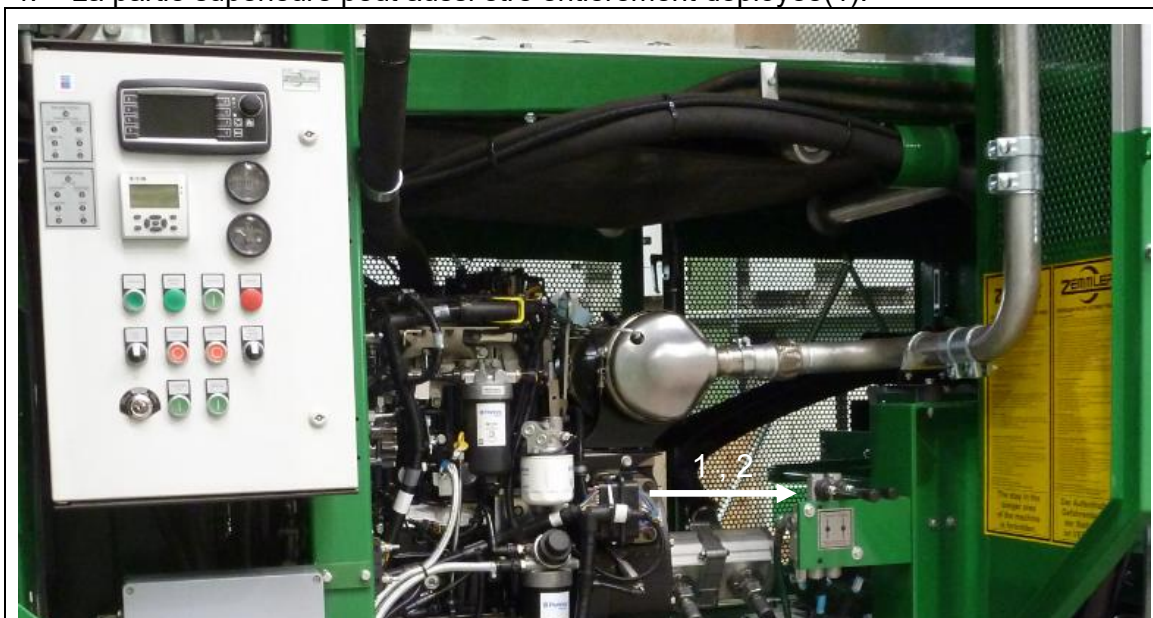
Fig. 8-3 :. Levier de commande pour la fraction fine
