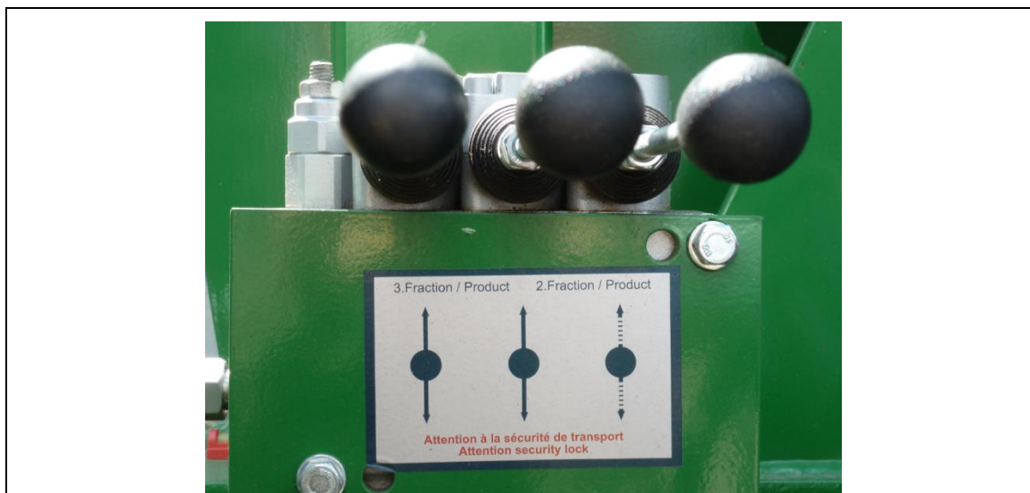
Fig. 8-5: Levier de commande des fractions moyenne et grossière étendue
