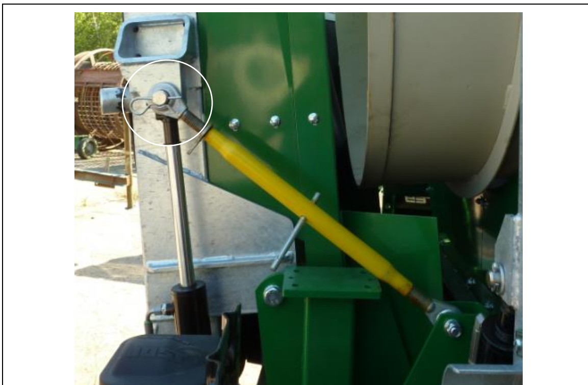
Fig. 7-6: Sécurité de transport fraction grossière
