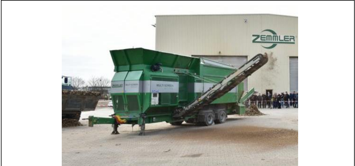
Fig. 6-1: Exemple de position de travail de l'installation de criblage
