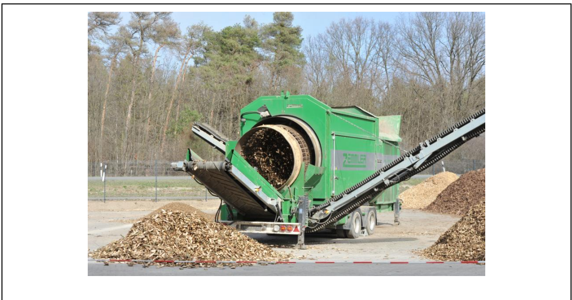
Fig. 6-2: Exemple de position de travail de l'installation de criblage
