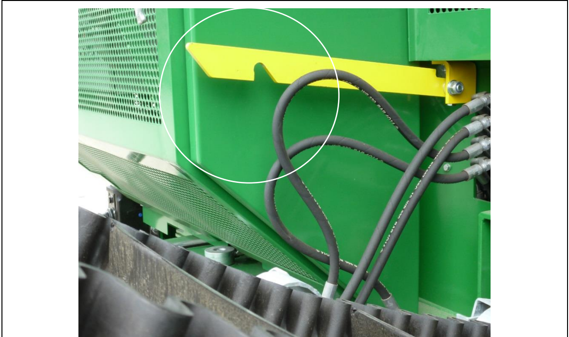
Fig. 7-3: Sécurité de transport fraction fine
