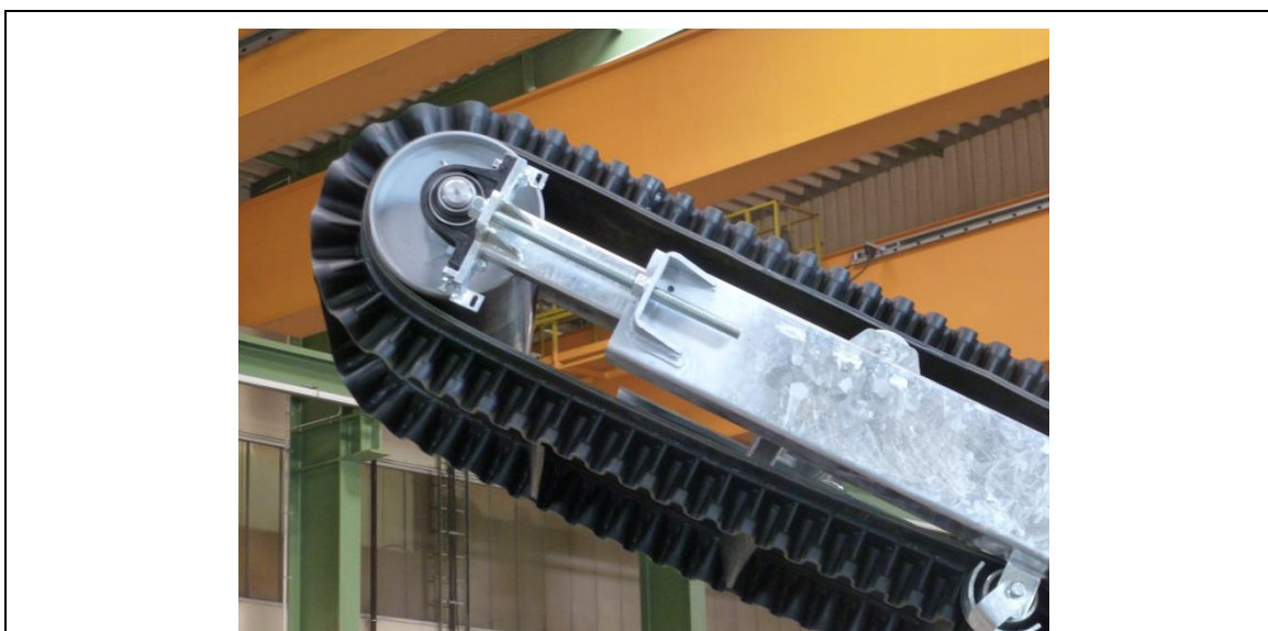
Fig. 8-10: Réglage supérieur des fractions fine et moyennes pour l'étirement des bandes
