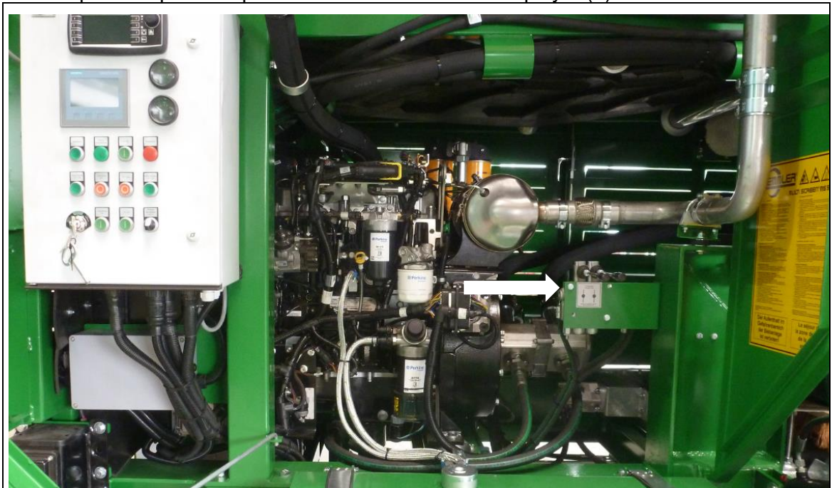
Fig. 8-3 :. Levier de commande pour la fraction fine
