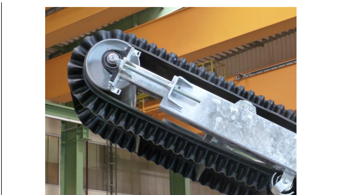
Fig. 8-8: Réglage supérieur des fractions fine et moyennes pour l'étirement des bandes
