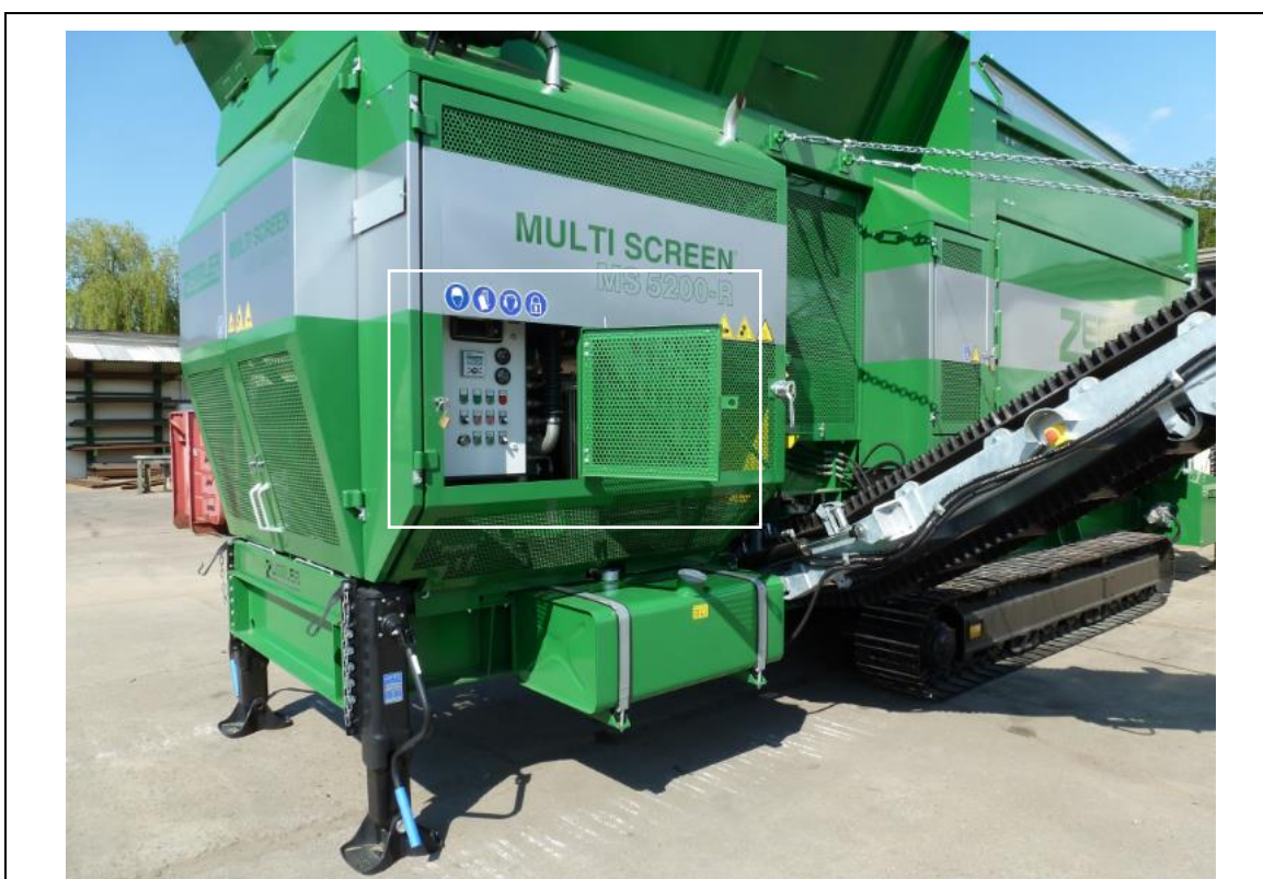
Fig. 8-1 : Porte de commande ouverte
