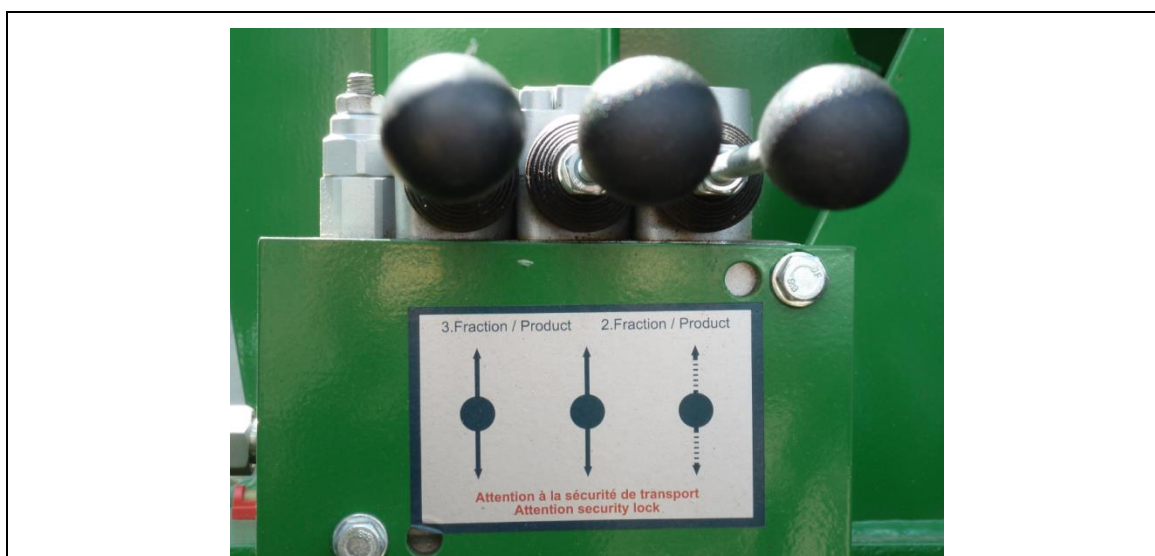
Fig. 8-4: Levier de commande des fractions moyenne et grossière étendue
