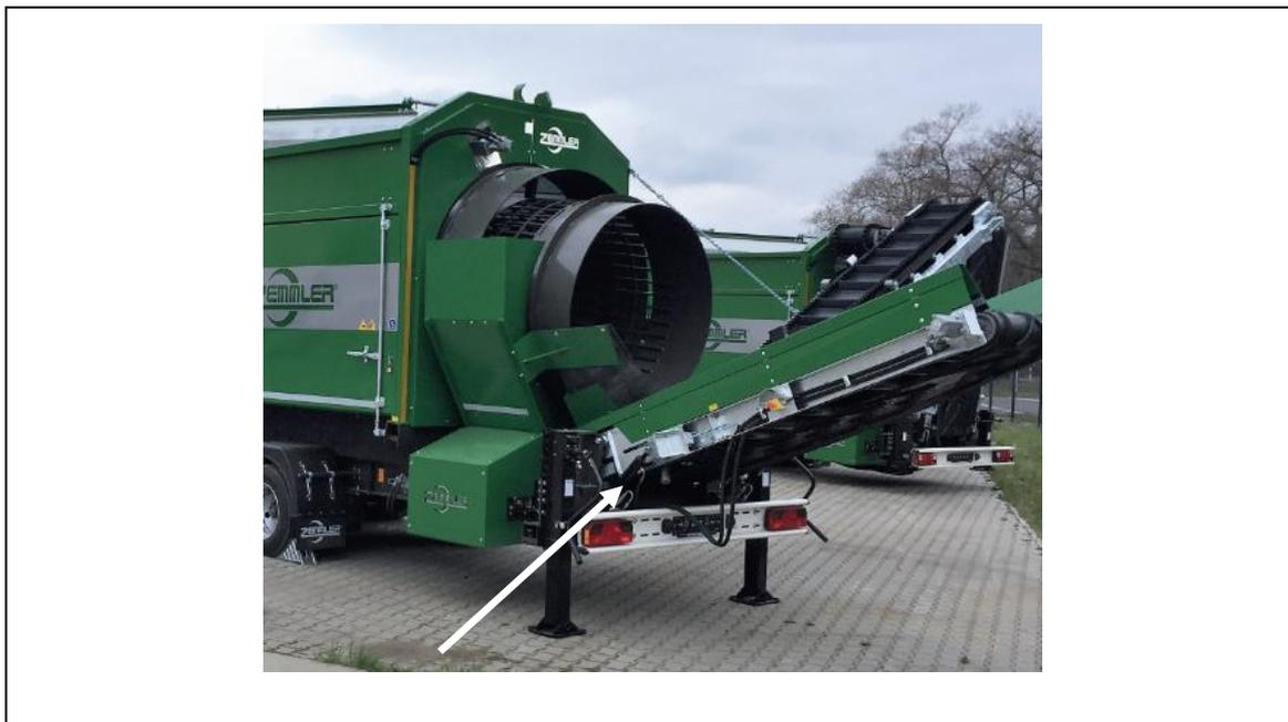
Fig. 8-7: Vis de réglage de la fraction grossière
