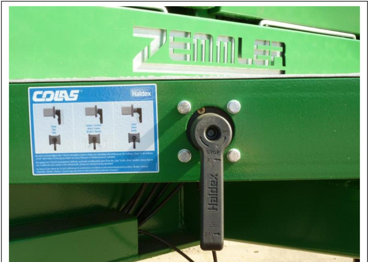
**Fig. 7-6: Contrôle de la hauteur de la suspension pneumatique**
