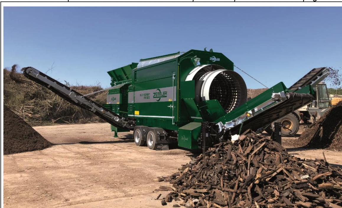
**Fig. 6-1: Exemple de position de travail de l'installation de criblage**
