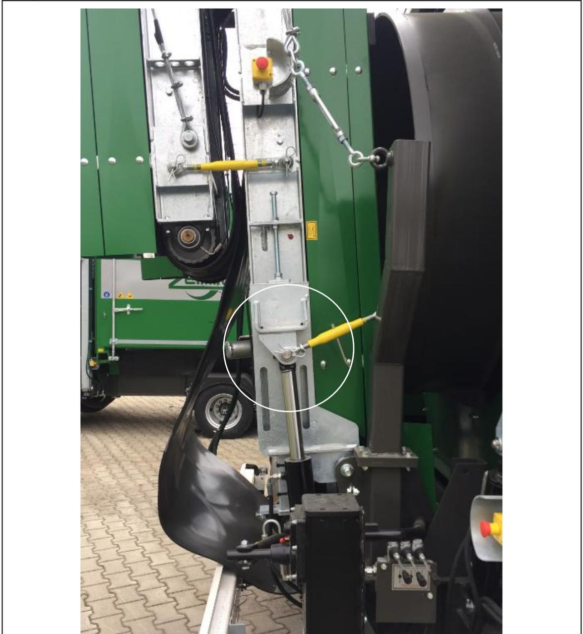
Fig. 7-5: Sécurité de transport fraction grossière d'extension
