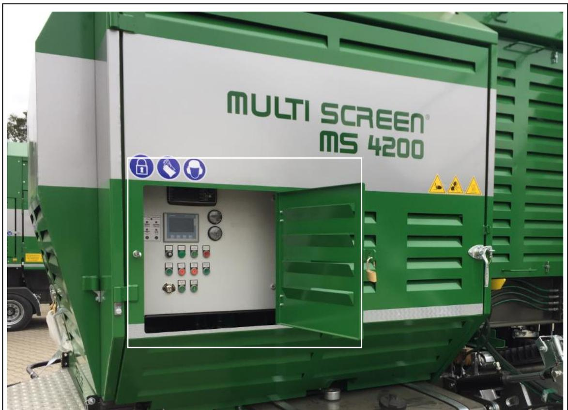
Fig. 8-1 : Porte de commande ouverte
