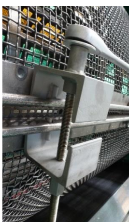
Figure 84: Serrage des cribles à l'aide du dispositif de serrage
