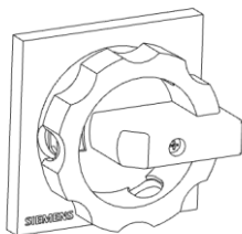
Figure 5: Interrupteur principal en position "ARRÊT"
