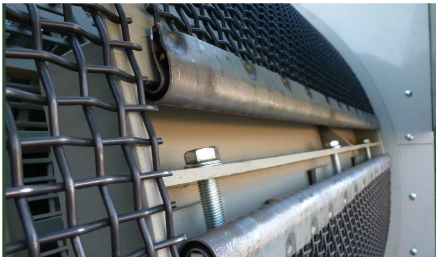
Figure 83: Éléments de serrage et vissage via la station de serrage
