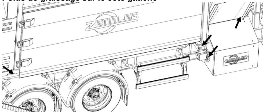
Figure 97: Position points de graissage boîtier à gauche (31,32,33,37,38,41,42)
