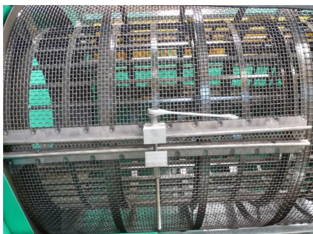
Figure 84: Serrage des cribles à l'aide du dispositif de serrage
