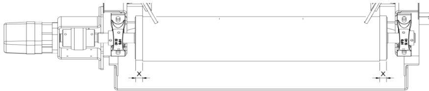
Figure 105: Contrôle course de la courroie transporteuse
